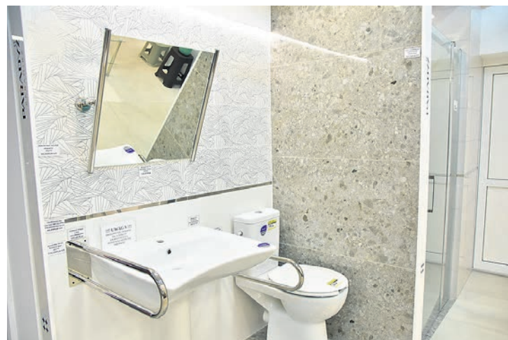
Łazienka przystosowana do potrzeb osoby niepełnosprawnej. Jest tu np. specjalny kompakt, nieco wyższy niż standardowy. Umywalka została wyprofilowana, jest możliwość swobodnego podjechania wózkem inwalidzkim.
