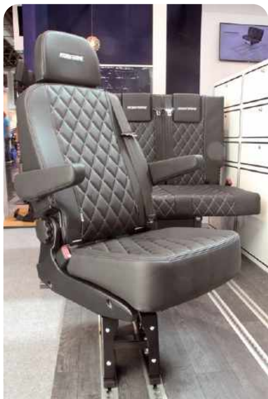
Mobiframe bardzo chwali się dopracowaniem mechanizmu blokowania w szynach podłogi. Nie bez powodu, skoro od teraz ma w swej ofercie obok dwu- i trzymiejscowych kanap również pojedyncze fotele obrotowe
