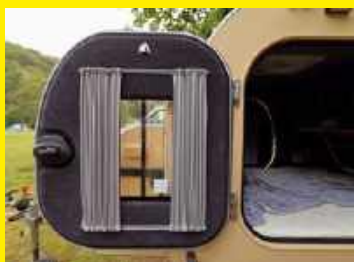
Drzwi to przykład dopasowania i elegancji; odsuwana szybka wraz z wywiewnikami i wentylatorem zapewni cyrkulację powietrza wewnątrz, a zasłony skutecznie obronią przed słońcem
