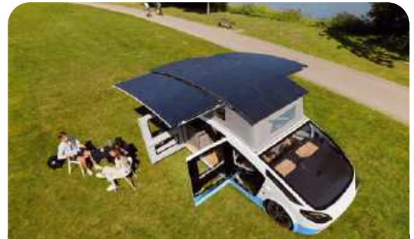
Cały dach pokryty jest panelami słonecznymi. Po jego rozłożeniu na postoju powierzchnia paneli słonecznych zwiększa się dwukrotnie – do 17,5 m 2
