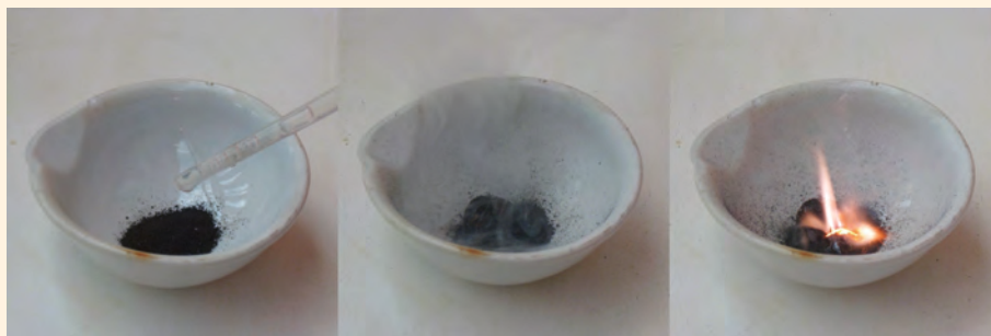
Doświadczenie 3: zwilżenie proszku nadmanganianu potasu gliceryną powoduje jej zapłon.
