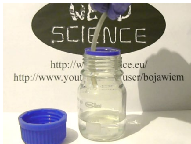
Fot. 4 – Wprowadzanie gazowego chloru ponad powierzchnię roztworu
