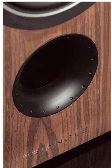
Wyprowadzenie bas-refleksu na skraju obudowy grozi silnym promieniowaniem fali stojącej, ale jakimś sposobem udało się w tym przypadku tego uniknąć, co stwierdzamy na podstawie własnych pomiarów
