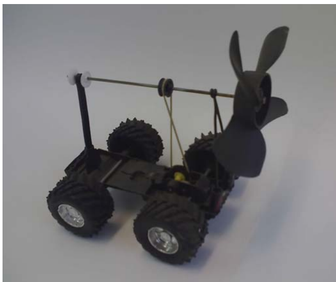
Fot. 1. Przykład wykonania modelu samochodu napędzanego wiatrem z wykorzystaniem elementów starej zabawki i śmigła od wentylatora chłodzącego komputer.
