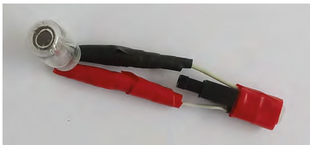
Fot. 3. Mechanizm uderzeniowy przyłączony do neonówki pozwala w efektywny sposób zademonstrować wytwarzanie napięcia piezoelektrycznego. Neonówka jest przeznaczona do świecenia po przyłożeniu napięcia sieciowego. Grube warstwy czerwonej izolacji chronią przed mało przyjemnym działaniem napięcia o takiej wielkości na skórę palców.
