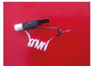
Fot. 2. Wygląd zewnętrzny wymontowanego z zapalarki mechanizmu uderzeniowego, zawierającego kryształ piezoelektryczny.
