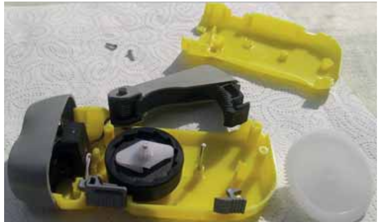
Fotografia 3. A – Latarka z dwoma wyświetlaczami z wykorzystaniem idei dynamy; B – wnętrze tak wykonanej latarki.
