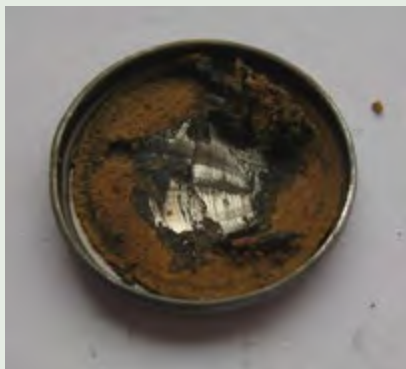
Odsłonięta powierzchnia metalicznego litu znajdującego się na fragmencie obudowy ogniwa.
