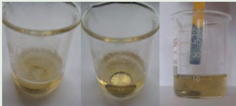
Roztworzenie litu w wodzie (od lewej): reakcja przebiegająca z wydzieleniem wodoru; widok po reakcji; badanie odczynu otrzymanego roztworu.
