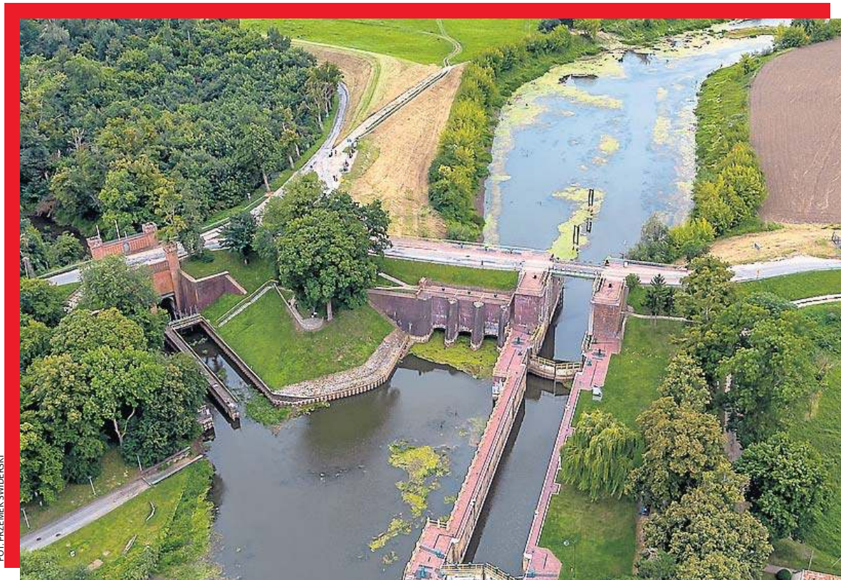
Węzeł wodny w Białej Górze. Po lewej stara śluza z 1852 r., po prawej stopień wodny z lat 1912-1916.
