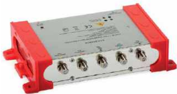
Nadajnik optyczny OTH-2500CW (4×SAT IF+ Terr) A9810 Signal
