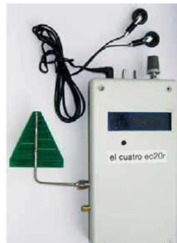
El Cuatro z wbudowanym odbiornikiem DRA818V i podłączonymi słuchawkami
