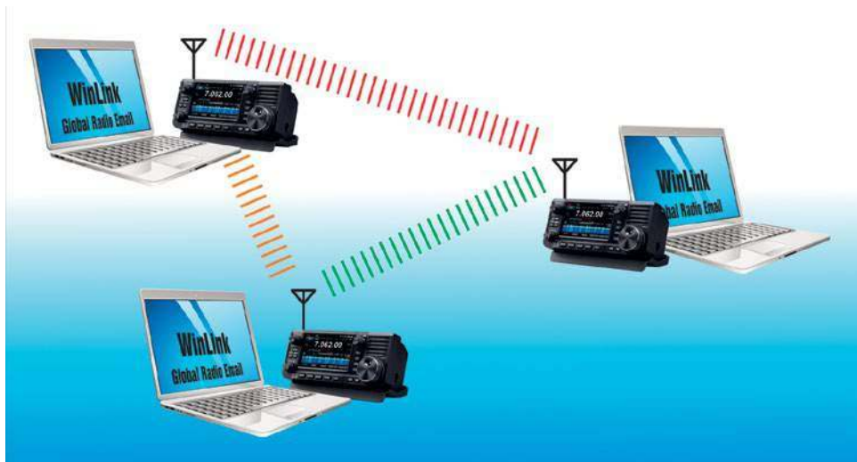
Rys. 4. WinLink pozwala na komunikację bezpośrednią pomiędzy dwoma wybranymi stacjami (peer-to-peer). Ze względu na kodowanie transmisji przesyłane drogą radiową dane są chronione przed dostępem przez inne stacje nasłuchowe
