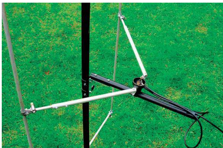
Konstrukcja obwodu dopasowującego wykonanego z rurek teleskopowych
