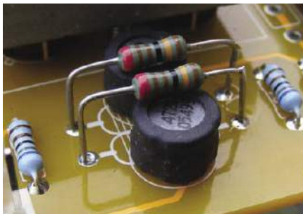
Rysunek 31. Aby zredukować niewielką ilość dzwonienia przy przebiegach prostokątnych, dławiki filtrów wejściowych L1 i L2 można wytłumić, podłączając do nich rezystory 1,3 k \Omega (R28 i R29)
