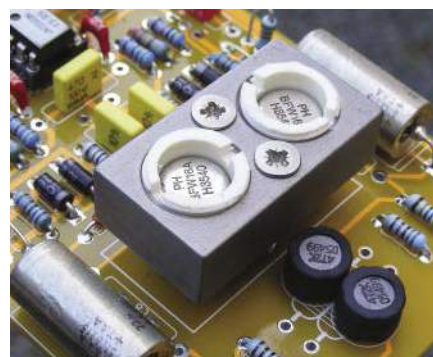
Rysunek 25. Na płytce PCB zapewniono możliwość zastosowania wspólnego radiatora celem zagwarantowania wzajemnego dryfu parametrów w obu tranzystorach. Nie jest to tutaj niezbędne (ani optymalne), opłaca się natomiast w przypadku syntezyatorów
