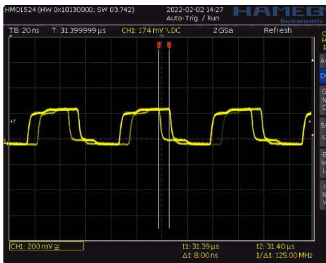
Rysunek 5. Wygenerowany sygnał zegarowy wykazuje drżenie zboczy (jitter)
