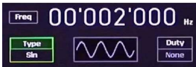
Ustawianie sygnału generatora funkcyjnego (© 2024 Jos Verstraten)
