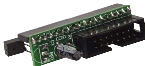
Jedna z tych płytek adaptera musi być podłączona do modułu Micromite Backpack, jak pokazano na głównym zdjęciu
