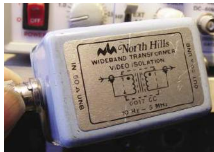
Rysunek 30. Podczas testowania zrównoważonych obwodów wejściowych konieczne jest użycie transformatora izolującego/równoważącego między wyjściem generatora sygnału a wejściem przedwzmacniacza
