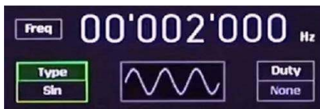
Ustawianie sygnału generatora funkcyjnego (© 2024 Jos Verstraten)
