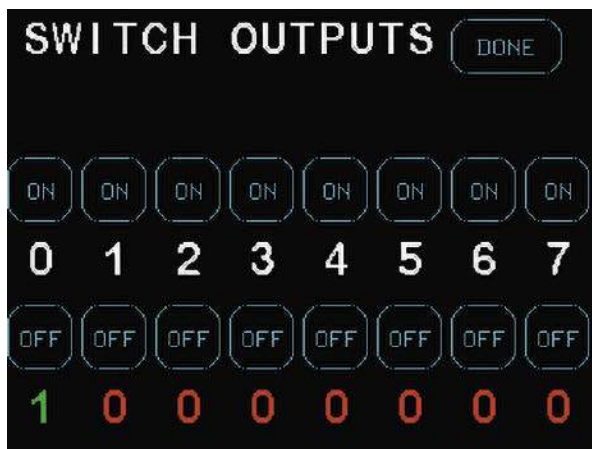
Ekran 4. Naciśnięcie przycisku SWITCHES na stronie EDIT TRIGGER umożliwia ustawienie wyjść SWITCH OUTPUT. Dostarczona przez Autorów przykładowa konfiguracja może pomóc Czytelnikowi w zrozumieniu tej funkcjonalności
