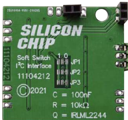
Ekspander we/wy (oznaczany również jako interfejs I 2 C) dodaje kolejną płytkę PCB do stosu menedżera baterii. Jeśli potrzebna jest większa liczba ekspanderów wejść/wyjść, można zamontować je za pomocą złączy (takich, jak używane w Arduino Shields). Należy pamiętać o ustawieniu różnych adresów I 2 C na ułożonych w stos płytkach PCB
