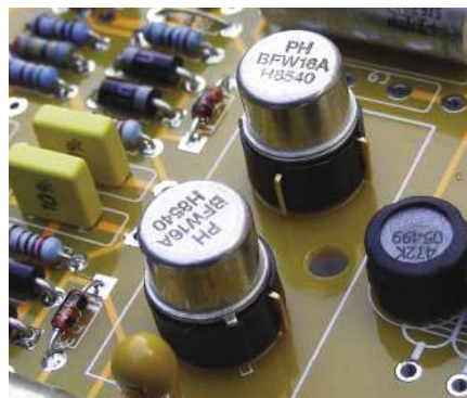
Rysunek 33. Tranzystory powinny być montowane w podstawkach, aby można było łatwo wymienić, na lepsze, te, które są zbyt szumiące. Tranzystory Hitachi, Toshiba, Sanyo i Rohm wydają się być najlepsze. Tylko elektronicy pasjonaci mają na to czas, więc możliwe jest uzyskanie lepszych parametrów niż w seryjnych urządzeniach
