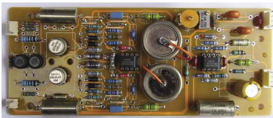
Rysunek 21. Warstwa opisowa PCB przedwzmacniacza mikrofonowego – należy zwrócić uwagę na polaryzację i orientację elementów zwłaszcza, jeżeli używane są inne tranzystory niż BFW16A
