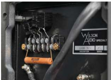
Po odkręceniu klapy w dolnej ścianie, mamy dostęp do rezystorów tłumika głośnika wysokotonowego
