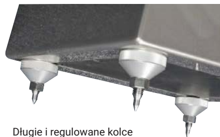
Długie i regulowane kolce stabilizowane w grubych nóżkach pozwalają ustawić kolumnę pewnie i dostroić jej pochylenie do pozycji miejsca odsłuchowego.
