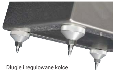
Długie i regulowane kolce stabilizowane w grubych nóżkach pozwalają ustawić kolumnę pewnie i dostroić jej pochylenie do pozycji miejsca odsłuchowego.
