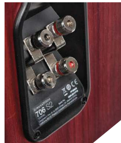
Terminal przyłączeniowy z podwójnymi zaciskami wygląda w większości Bowersów podobnie, i chociaż przypomina standardowe „puszki”, to jest solidny i wygodny.
