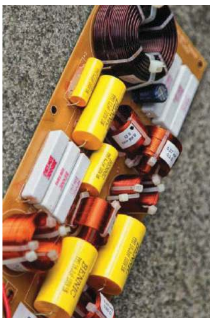
Zwrotnica S300 mk II jest wyjątkowo skomplikowana jak na układ dwudrożny, chociaż wcale niekoniecznie z „ostrym” filtrowaniem, za to z korekcjami.
