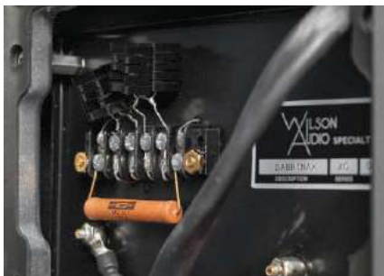
Po odkręceniu klapy w dolnej ścianie, mamy dostęp do rezystorów tłumika głośnika wysokotonowego
