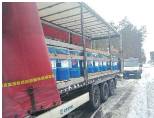
Stalowe bębny z farbą nie były umocowane. Podczas manewrów na drodze mogły spaść na inne pojazdy lub pieszych
