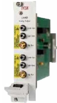
Fotografia 12. Karta rozszerzeń z funkcją dwukanałowego tachometru światłowodowego marki IFTA Systems ( http://t.ly/VzMbb )
