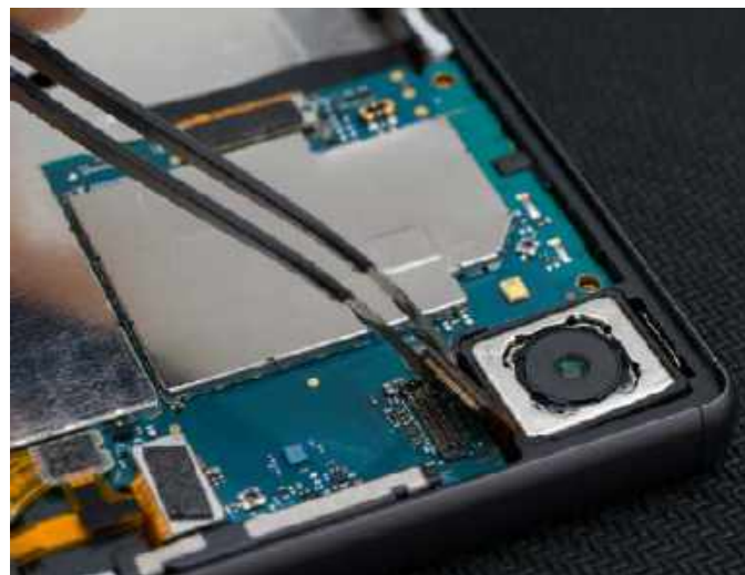
Fotografia 1. Wnętrze smartfona z widocznymi taśmami FPC (uniesiona pęsetą część ukazuje gniazdo Mezzanine znajdujące się na PCB tuż obok modułu kamery)
