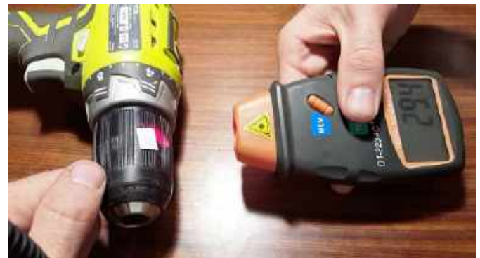
Fotografia 4. Pomiar prędkości obrotowej wkrętarki z użyciem znacznika samoprzylepnego i tachometru laserowego ( http://t.ly/slM0- )
