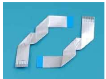
Fotografia 10. Przewody FFC z fabrycznie wykonanymi zagięciami ( https://tinyurl.com/35b2f3vr )
