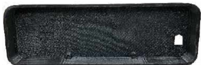
Fotografia 3. Widok obudowy urządzenia wydrukowanej w technologii FDM
