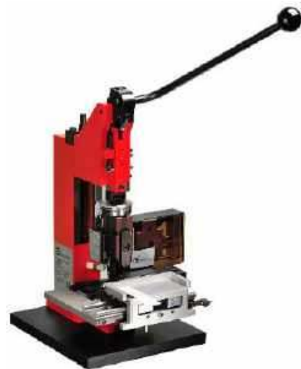
Fotografia 19. Przykładowa zaciskarka ręczna do złączy typu Crimpflex ( http://tinyurl.com/2ebk5b2b )
