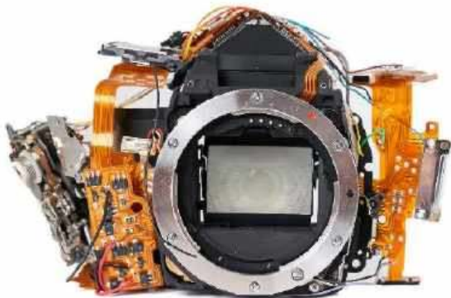
Fotografia 9. Widok wnętrza korpusu lustrzanki z licznymi taśmami FPC i obwodami rigid-flex ( http://tinyurl.com/9m7c293k )
