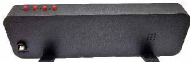
Fotografia 4. Widok tylnej części obudowy urządzenia wydrukowanej w technologii MJF
