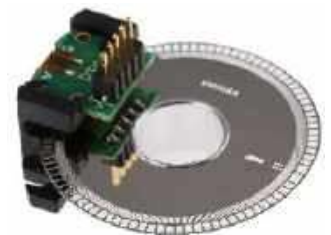
Fotografia 13. Enkoder inkrementalny marki Broadcom ( http://t.ly/PBAVG )
