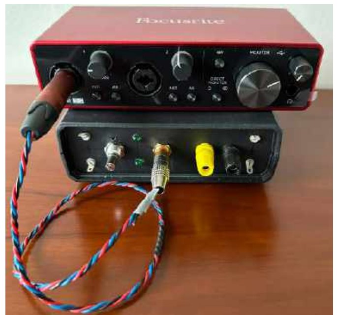
Fotografia 3. Połączenie wejścia karty ze sztucznym obciążeniem
