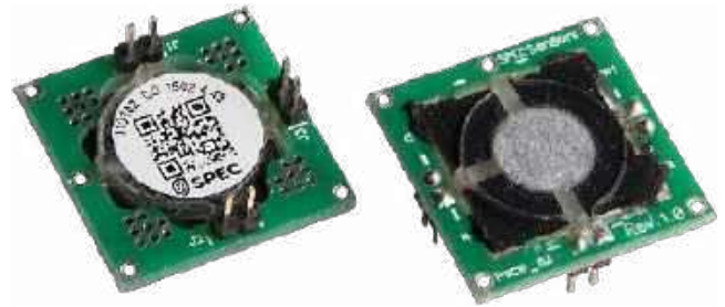
Fotografia 1. Czujnik tlenku węgla typu 110-102 firmy SPEC Sensors: widok z dołu (po lewej), widok z góry (po prawej) [2]
