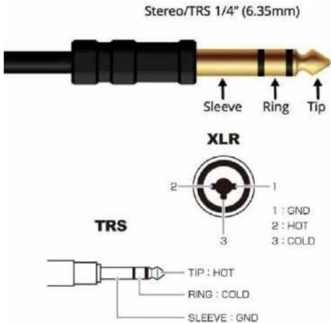
Rysunek 4. Schemat połączeń wtyków TRS i XLR w przypadku sygnałów zbalansowanych
