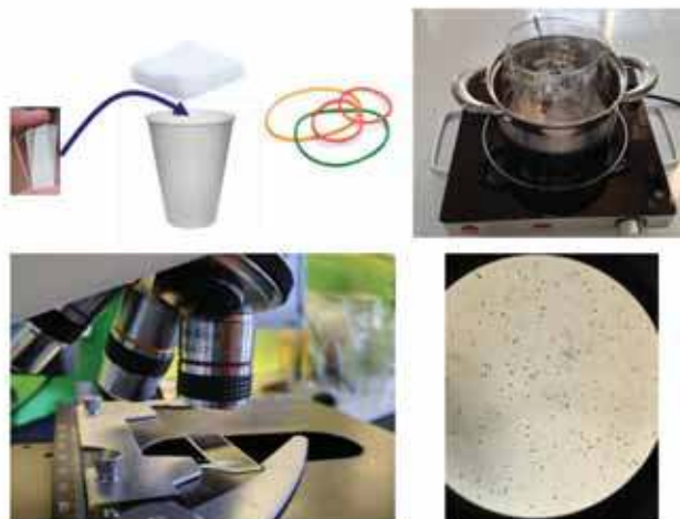
Ilustracja 3. Zdjęcia szkolnego układu pomiarowego. U góry, z lewej strony – pojemnik na detektor, z prawej – płyta grzewcza z garnkiem do wytrawiania. Na dole, z lewej strony – szkolny mikroskop, z prawej – obraz spod mikroskopu uzyskany telefonem komórkowym.
