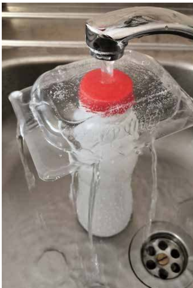
Fot. 4. Skutek użycia do doświadczenia przedmiotu o zbyt dużej powierzchni – plastikowej tacki od produktów spożywczych.
