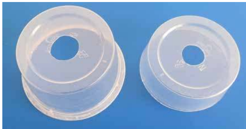
Fot. 11. Przyrząd do naprężania tkaniny, ułatwiający obserwacje efektów optycznych: a) części składowe, b) widok po złożeniu.
