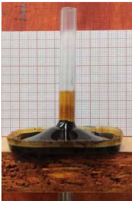
Fot. 3. Efekt Mojżesza w polu magnetycznym, wytwarzanym przez „pręcik” złożony z małych magnesów neodymowych, wsuwanych od dołu do rurki – kształt powierzchni swobodnej cieczy dla różnych położeń magnesu. Magnes jest widoczny u dołu rurki. 3.a.
