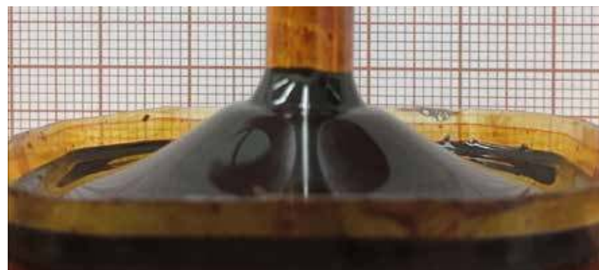
Fot. 3. Efekt Mojżesza w polu magnetycznym, wytwarzanym przez „pręcik” złożony z małych magnesów neodymowych, wsuwanych od dołu do rurki – kształt powierzchni swobodnej cieczy dla różnych położeń magnesu. Magnes jest widoczny u dołu rurki. 3.a.
