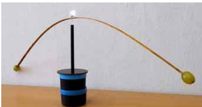
Fot. 1. Wygląd wykonanej listewki do wykrywania materiałów magnetycznych z owocami winogrona na końcach.
