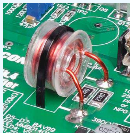
Ten widok przedstawia cewkę indukcyjną L1 nawiniętą na szpulce z maszyny do szycia. Aby uzyskać 2,2 \mu\text{H} , należy nawinąć 17,5 zwojów emaliowanego drutu miedzianego o średnicy 1,25 mm (o cztery więcej niż w przypadku szpułek stosowanych w części drugiej artykułu).
