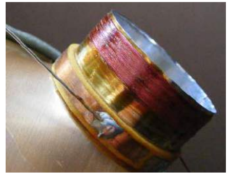
Rysunek 56. Cewka nawinięta na aluminiowym karkasie. Podejrzewam, że powoduje to problemy z indukowaniem się prądów wirowych.
