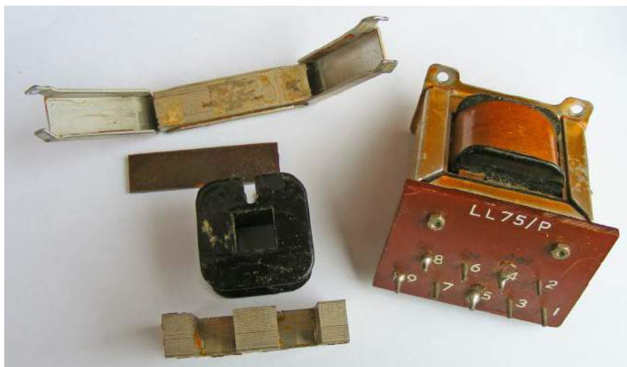
Rysunek 38. Cewka głośnikowa Radiometal używana przez BBC. Łączy ona w sobie niskie zniekształcenia cewek z rdzeniem powietrznym z niską rezystancją rdzeni ferrytowych. Laminaty na bazie niklu mają jasny kolor, a nie matowoszary jak rdzenie transformatorów krzemowo-żelaznych.
