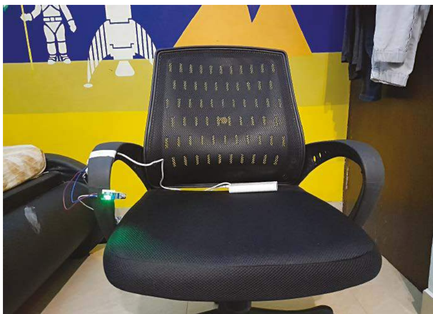
Rysunek 4. Opracowany przez autora nadajnik z czujnikiem podczerwiieni zamocowany na krześle
