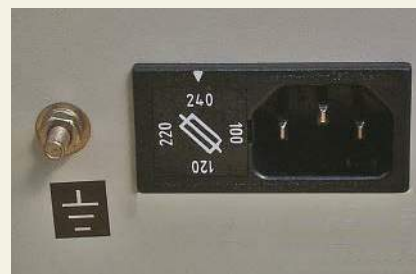
Rysunek 4.18. Bezpiecznikowy selektor sieciowy łączący wybór napięcia sieciowego ze standardową oprawką bezpiecznikową 20 mm i złączem sieciowym IEC (wymagana jest większa wartość prądu znamionowego do pracy przy napięciu 110/120 V). Zauważ zewnętrzny port uzziemienia, który umożliwia połączenie z innymi urządzeniami.
