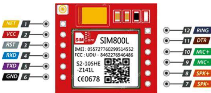
Rysunek 2. Szczegółowe informacje o stykach SIM800L
