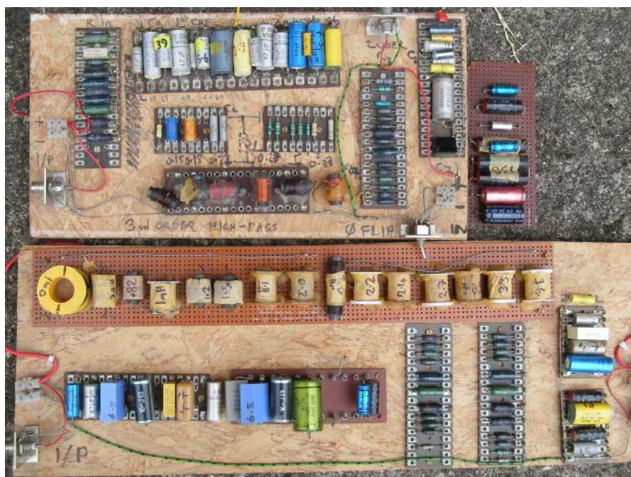
Rysunek 35. Jedna z moich płytek testowych zwrotnicy z lat 90. Ponieważ większość głośników ma niską impedancję i wąski zakres częstotliwości zwrotnicy, szeroki zakres wartości nie jest potrzebny. W prezentowanym przypadku mogą użyć: od 0,1 do 6 mH dla cewek, 0,22 μF do 22 μF dla kondensatorów i 0,22 do 330 Ω dla rezystorów.
