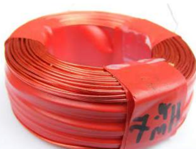
Rysunek 40. Cewka z rdzeniem powietrznym – wymaga wielu zwojów, aby uzyskać wymaganą indukcyjność, co zwiększa koszty i rezystancję. Mają one bardzo małe zniekształcenia i są łatwe do samodzielnego wykonania, jak pokazuje ten przykład. Cewka trzyma się w całości za pomocą czerwonej taśmy izolacyjnej.
