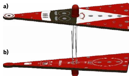
Rysunek 5. a) obudowa diody LED stanowi nos Mikotaja, stąd znajduje się po stronie jego twarzy; b) wyprowadzenia diody LED skierowane są w stronę spodu, gdzie w następnym etapie zostaną zamontowane przełącznik oraz koszyk z baterią CR2032
