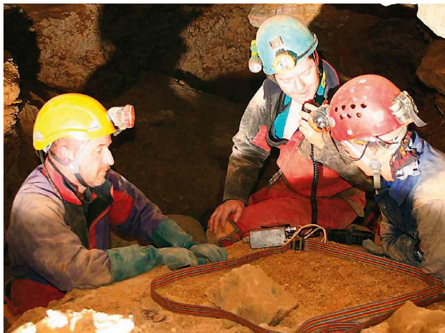
Rysunek 35. Obsługa Molefone w jaskiniach Matienzo, Hiszpania. Zwróć uwagę na antenę pętlową wykonaną z komputerowego przewodu taśmowego. (źródło: http://matienzocaves.org.uk/ugpics/2366-2007e-molepe.htm )
