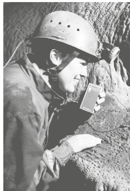
Rysunek 38. Jill Rowling ze Speleונים używająca jednoprzewodowego telefonu Michiephone. Źródło: www.speleונים.com.au/business/ (powielone za zgodą)
