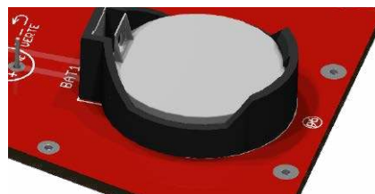
Rysunek 1. Bateria CR2032 zamontowana w przeznaczonym dla niej gnieździe na tylnej ścianie każdej z figurek. Bateria taka łatwo może zostać przez małe dziecko zdemonstrowana i połknięta, dlatego przed udostępnieniem zabawki dziecku przeczytaj koniecznie akapit „Bawmy się i uczmy bezpiecznie” i zachowaj ostrożność
