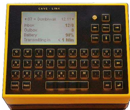
Rysunek 37. Terminal Cave-link do wysyłania danych tekstowych przez VLF przez ziemię. Źródło: https://expo.survex.com/expofiles/documents/hardware/Cavelink2.13_en_2014-3.pdf
