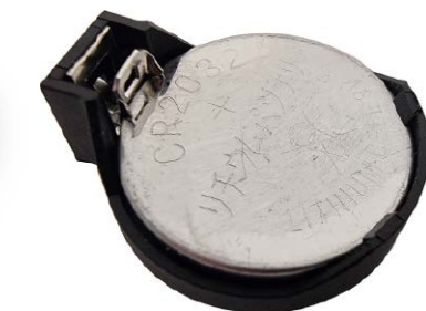
Fotografia 5. Poprawny montaż baterii CR2032 w uchwycie, plusem do góry
