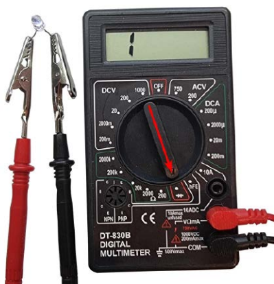
Fotografia 7. Sprawdzenie diody LED za pomocą multimetru ustawionego na funkcję testowania diod. Po przyłożeniu sondy czerwonej do anody, a czarnej do katody, sprawna dioda LED powinna się zaświecić. Jeśli dioda ma odpowiednio długie (jeszcze nie przycięte) wyprowadzenia można się wspomóc krokodylkami
