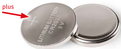
Fotografia 3. Oznakowanie biegunowości na ogniwie CR2032. Na jednej ze stron znajduje się znak „+” wskazujący dodatni biegun baterii. Po przeciwnej stronie nie ma żadnego oznakowania – to właśnie „minus” ogniwa
