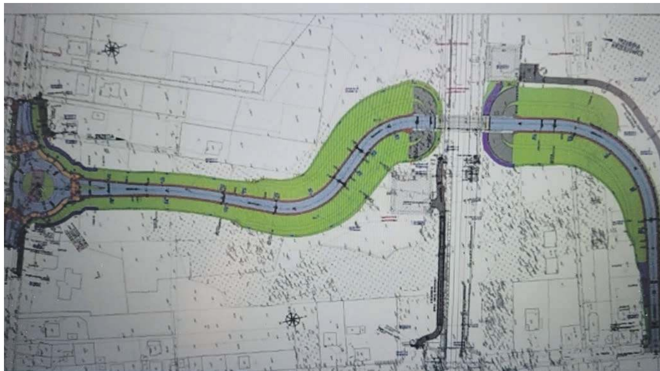
Plan przebiegu wiaduktu w Młoszowej - wersja najnowsza. Widoczne z lewej strony rondo znajdzie się ok. 100 m za wylotem ul. Trzeciej w Młoszowej, jadąc od Trzebini
