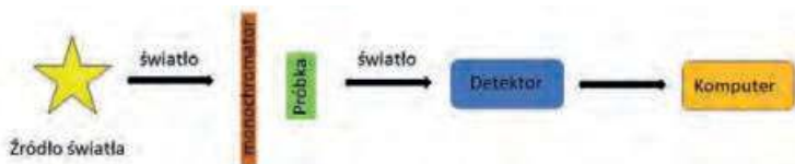
Rys. 3. Ogólna zasada pomiaru spektroskopowego.
