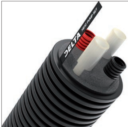
Fot. 4. Rura preizolowana przygotowana do instalacji monoblokowych pomp ciepła: izolacja z pianki polietylenowej w karbowanej rurze osłonowej (HDPE) odpornej na promienie UV, rura przewodowa z polietylenu typu PEX oraz peszle do przewodów zasilającego i sterującego sygnałem
