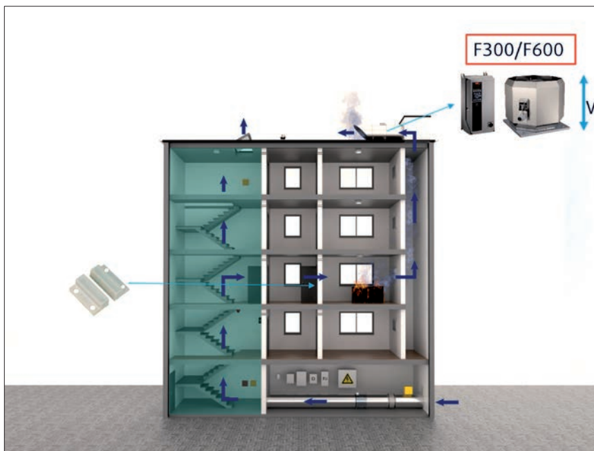
Rys. 1. Schemat regulacji aktywnego upustu powietrza od sygnału otwarcia drzwi – system SMOKE-AXC firmy Systemair Źródło: Systemair
