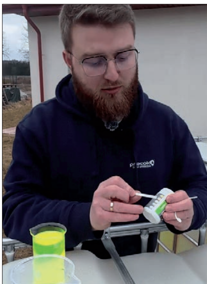
Fot. 6. Własności płynu instalacyjnego można łatwo sprawdzić za pomocą szybkiego testu paskowego
