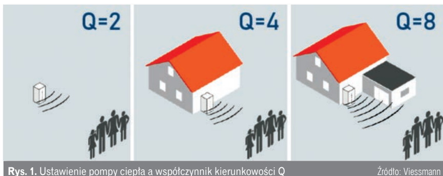
Rys. 1. Ustawienie pompy ciepła a współczynnik kierunkowości Q
