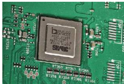
Jednym z najważniejszych układów w cyfrowej sekcji audio jest dwurdzeniowy procesor Analog Devices z rodziny SHARC.
