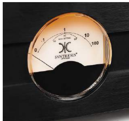
Wskaźnik mocy wyjściowej można wykorzystać w trybie kalibracji biasu lamp KT88.
