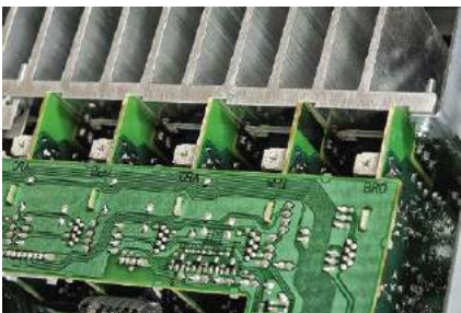
Końcówki mocy mają formę niezależnych, pionowych modułów; w każdym pracuje para tranzystorów 2SB1647/2SD2560.
