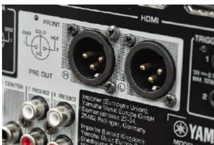
Gniazda zbalansowane (XLR) to rarytas nawet w najdroższych, zintegrowanych wzmacniaczach AV.
