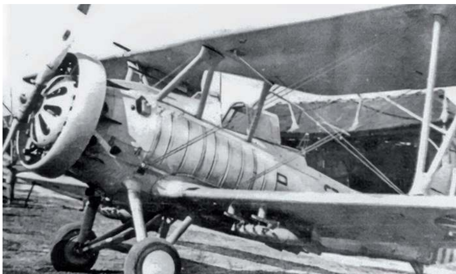
◀ Vought V-92-C Corsair. Widoczne bomby podwieszone na wyrzutnikach pod skrzydłami. Chińczycy zakupili dwadzieścia maszyn w tej wersji.
