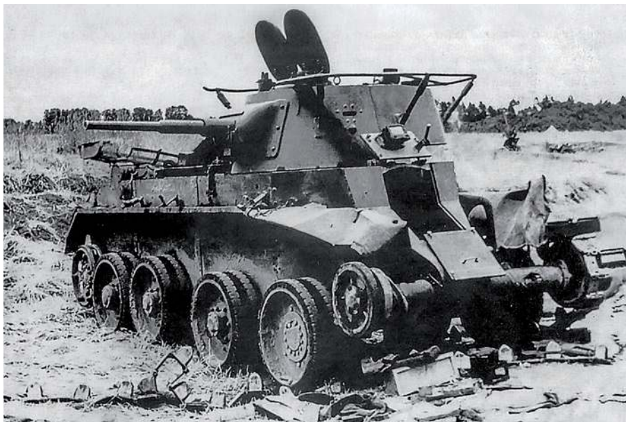
▲ Unieszkodliwiony podczas walk o Siemno czołg lekki BT-7. Ciekawostką jest poręczowa antena raczej rzadko spotykana na wozach ze stożkową wieżą. Widocznie były dostępne jedynie radiostacje 71-TK-1 wymagające takiego rozwiązania. Czołg stracił gąsienicę przypuszczalnie podczas próby wykonania gwałtownego skrętu.
