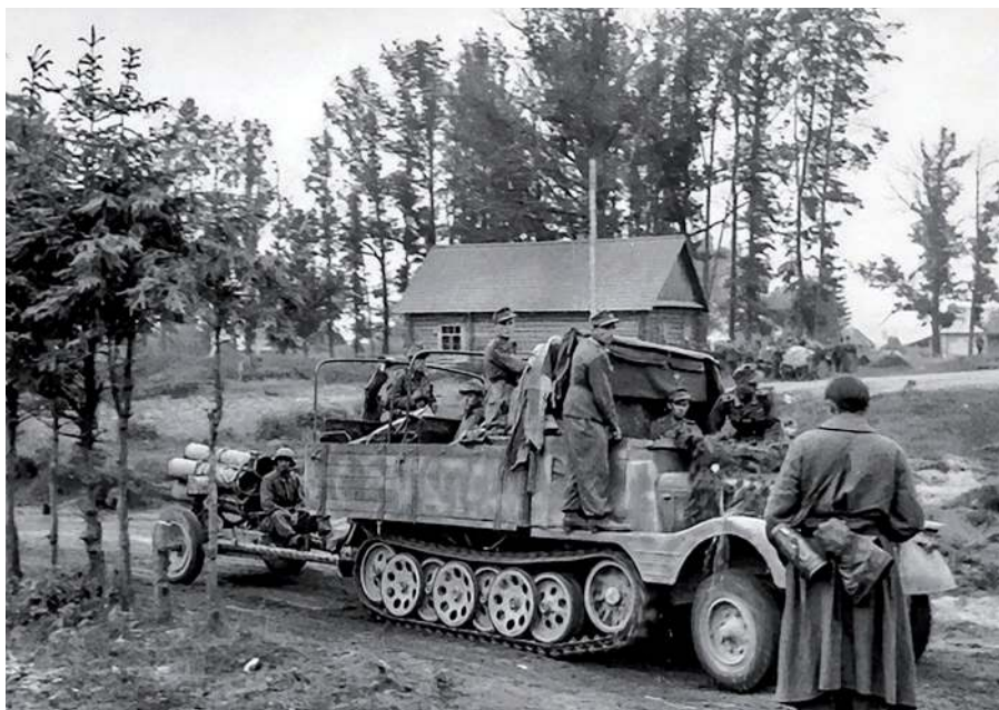
▲ Sd.Kfz.11/5 Schwer Nebelkraftwagen holujący wyrzutnię 21 cm Nebelwerfer 42. Ten wariant ciągnika z uproszczoną tylną część nadwozia wykonaną głównie z drewna wprowadzono do służby w 1943 roku.
