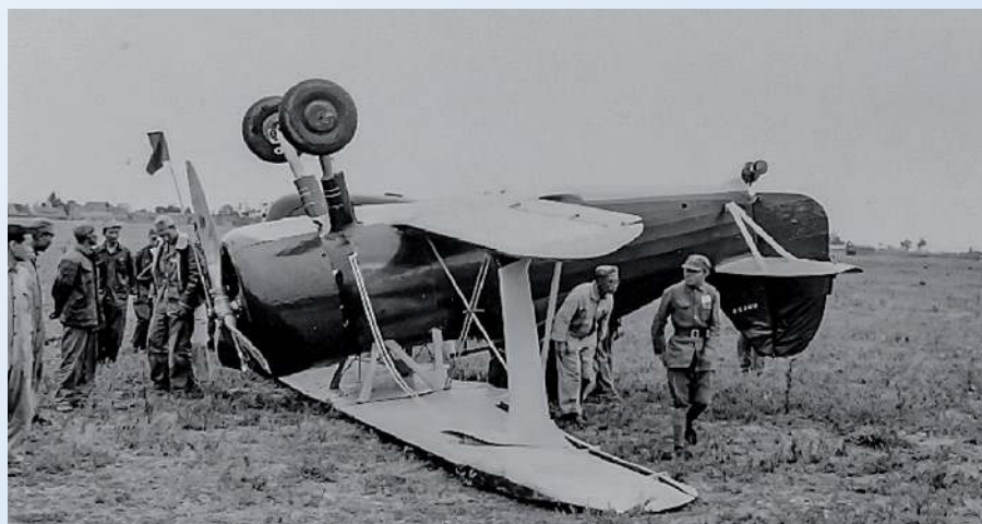
▲ Chung-28 Yi (Zhong-28 Yi) P-8053 po kapotażu. Była to chińska kopia I-15 bis. Z powodu braku zapasowych silników M-25W montowano amerykańskie Wright SR-1820F-53 Cyclone . Planowano zbudować 100 samolotów, ale wydaje się, że w latach 1941–1943 powstało ich jedynie 30. Były wyposażone w trójpłatowe metalowe śmigła Hamilton Standard z Hawków III . Osłona silnika była krótsza i nie miała wlotu powietrza na górze. Zmniejszono wyloty rur wydechowych. Używano także opon z Hawków II i III , a płożę ogonową zastąpiono małym kółkiem z owiewką.
