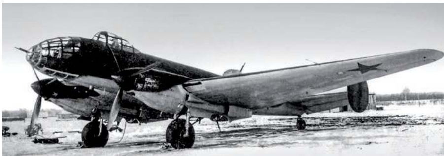
▲ Mało znany obrońca moskiewskiego nieba, średni bombowiec Jer-2. Był to samolot o nietypowej konstrukcji – jednoosobowa kabina znajdowała się z lewej strony na grzbiecie kadłuba, a skrzydła w widoku od przodu miały kształt spłaszczonej litery W, podobnie jak niemieckie Stukasy . Samoloty tego typu działały zarówno w dzień, jak i w nocy.
