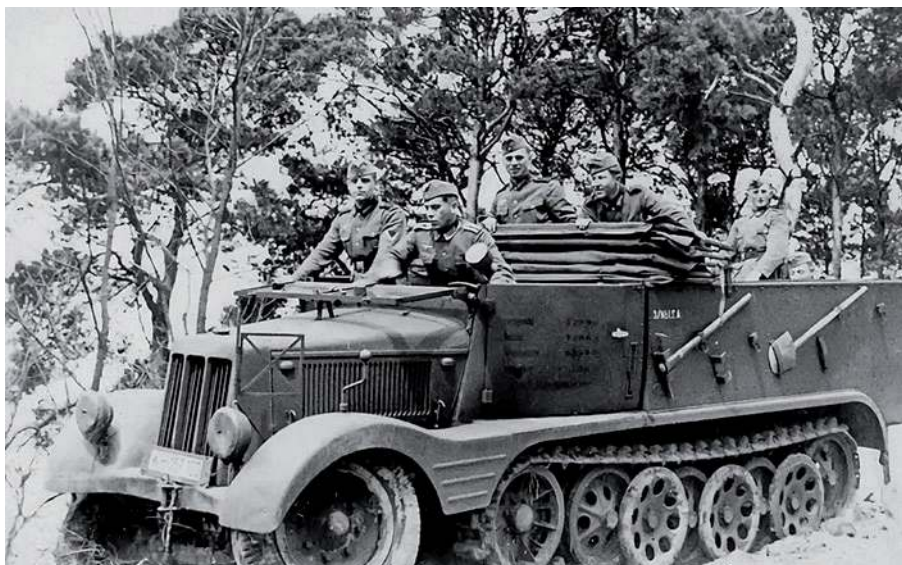
▲ Sd.Kfz.11 mit Pionier-Aufbau. Dobrze widoczne charakterystyczne cechy nadwozia dla jednostek saperskich czyli brak bocznych schowków i montowanie narzędzi saperskich na zewnątrz na uchwytach i zaciskach.
