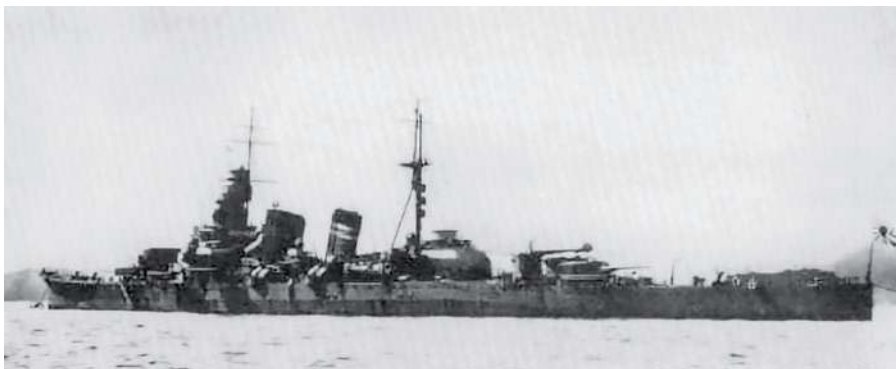
▲ Kinugasa podczas postoju na kotwicy w 1936 r. Na zdjęciu widoczna jest katapulta dla wodnosamolotów przed wieżą nr 3.
