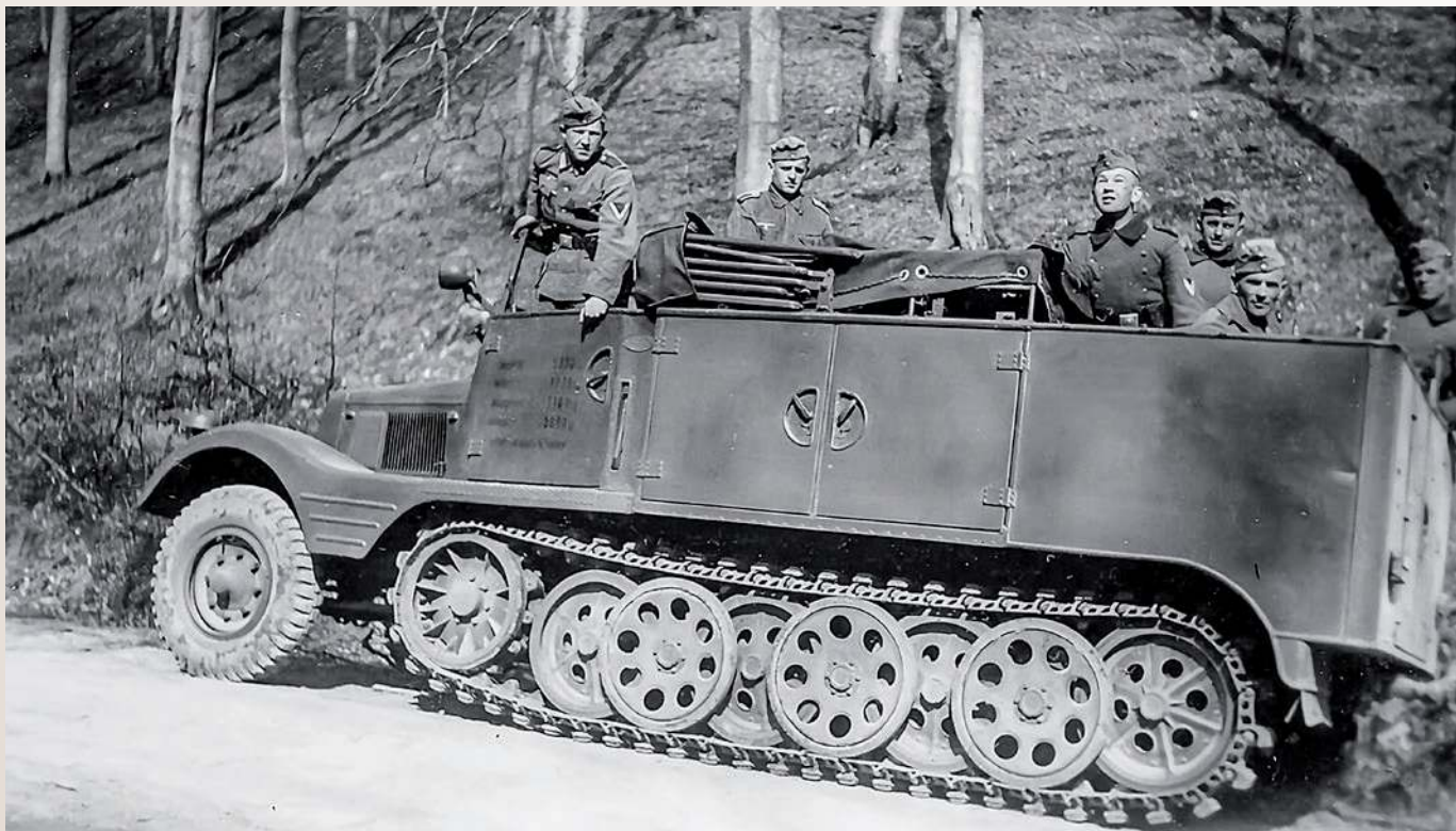
▼ Sd.Kfz. 11/1 Nebelkraftwagen produkcji Hansa-Lloyd/Borgward. Widoczna wyższa i szersza kabina kierowcy z płaskimi drzwiami, szersze nadwozie zajmujące całą szerokość podwozia, większe zasobniki amunicyjne oraz tylne dwuskrzydłowe drzwi.
