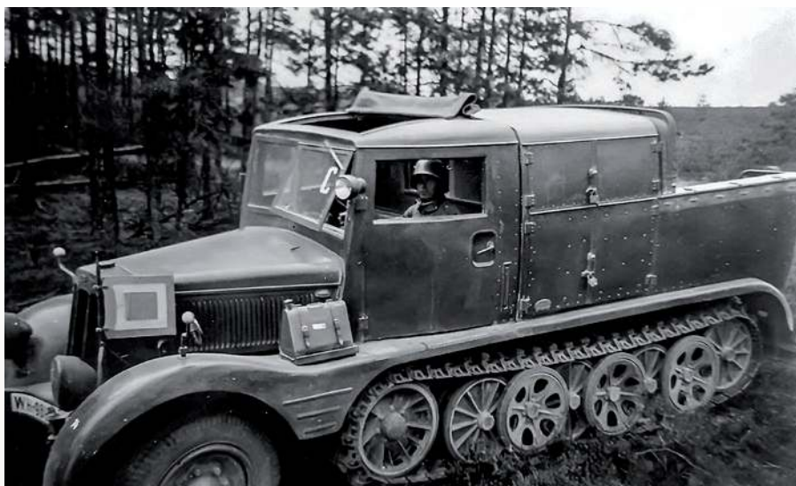
▲ Lekki ciągnik le.Zgkw. 3t (Sd.Kfz. 11) na podwoziu Hansa Lloyd HL kl 5, wyposażony w zamkniętą kabinę kierowcy oraz podwyższoną sekcję w tylnej części nadwozia.
