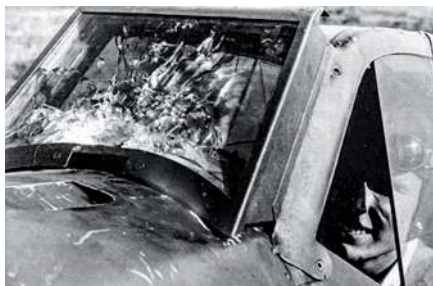
▲ Wiosną 1941 na przedniej szybie osłony kabiny Bf 109 zaczęto instalować dodatkowe szyby pancerne, ale nie wszyscy byli temu chętni. Kiedy 12 lipca 1941 roku dowódca 6./JG 3, Oblt. Heinrich Sannemann, zaatakował formację bombowców WWS został trafiony przez strzelca i przeżył dzięki szybie pancernej. Wieść szybko rozeszła się po jednostkach Luftwaffe i zaczęto je montować we wszystkich Messerschmittach, także Bf 110. Na zdjęciu Oblt. Sannemann po powrocie na lotnisko.
