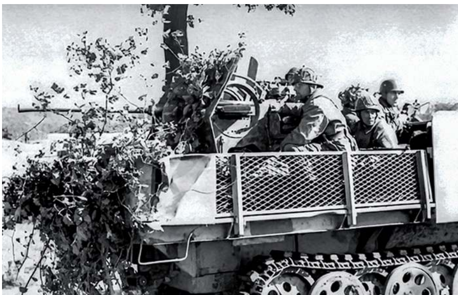
▲ Przeciwlotniczy 2cm Flak 38 auf Selbstfahrlafette Zgkw 3t Sd.Kfz.11. Pojazd ten powstał pomimo, że Wehrmacht już dysponował praktycznie identycznym Sd.Kfz.251/17.
