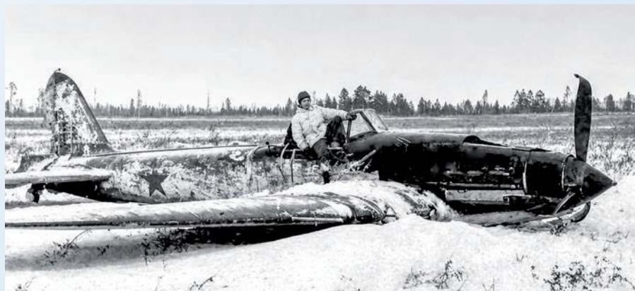
▲ Zestrzelony Il-2 po przymusowym lądowaniu na zamrożonej ziemi. Jego pilot prawdopodobnie przeżył kraksę, gdyż kabina szturmowca była od dołu dobrze opancerzona, podobnie jak silnik i zbiornik paliwa. Jednak Niemcy po zbadaniu zdobytych Ilów wyrażali się o nich bardzo negatywnie uznając je za niezbyt przydatne na polu walki. Faktycznie największą zaletą Ilów była liczba zbudowanych egzemplarzy i ich zmasowane użycie na linii frontu.
