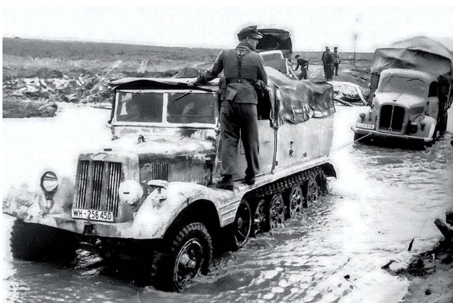
▲ Ciągnik Sd.Kfz.11 wyciąga z tarapatów 3-tonową ciężarówkę Borgward B 3000. Lekkie pojazdy półgąsienicowe jak Sd.Kfz.10, Sd.Kfz.11 czy ich wersje opancerzone Sd.Kfz.250 i Sd.Kfz.251 świetnie radziły sobie w trudnym terenie frontu wschodniego, zwłaszcza z wszechobecnym błotem.
