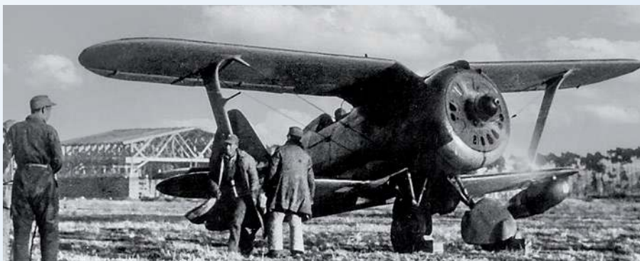
◀ Polikarpow I-153 Chińskich Sił Powietrznych. Zwracając uwagę dodatkowe zbiorniki paliwa.
