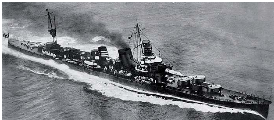
▲ Kako podczas ćwiczeń w Zatoce Tokijskiej w 1928 r. Krążownik płynie z dużą prędkością. Widać wieże artylerii głównej zwrócone na lewą burtę i do tyłu.
