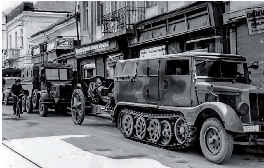
▲ Ciągnik Sd.Kfz.11 wyciąga z tarapatów 3-tonową ciężarówkę Borgward B 3000. Lekkie pojazdy półgąsienicowe jak Sd.Kfz.10, Sd.Kfz.11 czy ich wersje opancerzone Sd.Kfz.250 i Sd.Kfz.251 świetnie radziły sobie w trudnym terenie frontu wschodniego, zwłaszcza z wszechobecnym błotem.
