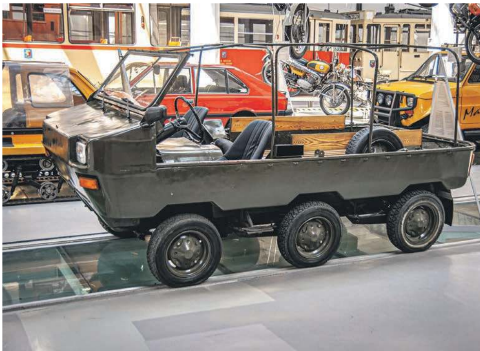
LPT prototyp przygotowany na potrzeby wojska, przeznaczony do ewakuacji rannych z pola walki lub transportu amunicji na polu walki.
