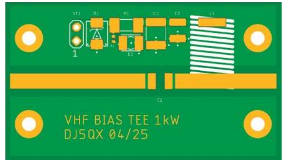
Rys. 4. Schemat montażu rozdzielacza prądu stałego, oryginalne wymiary 51 mm×30 mm
