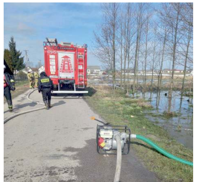
Działania strażaków polegały na wypompowywaniu wody za pomocą pompy szlamowej do wody brudnej
