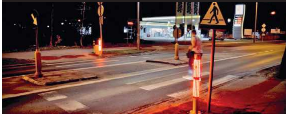
■ System safepass ułatwia przechodzenie przez tzw. zebę. W momencie, gdy pieszy chce przekroczyć jezdnię uruchamiają się sygnalizatory świetlne
