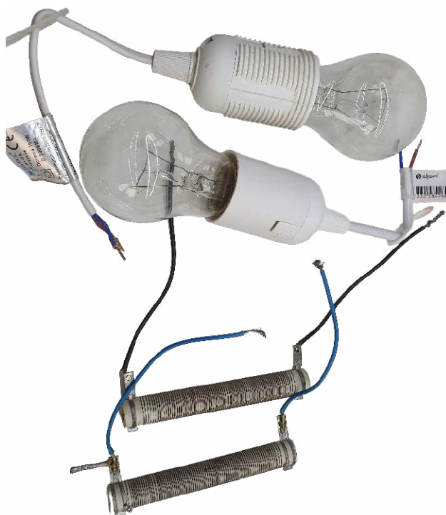
Fotografia 10. Rezystory i żarówki do ograniczania prądu
