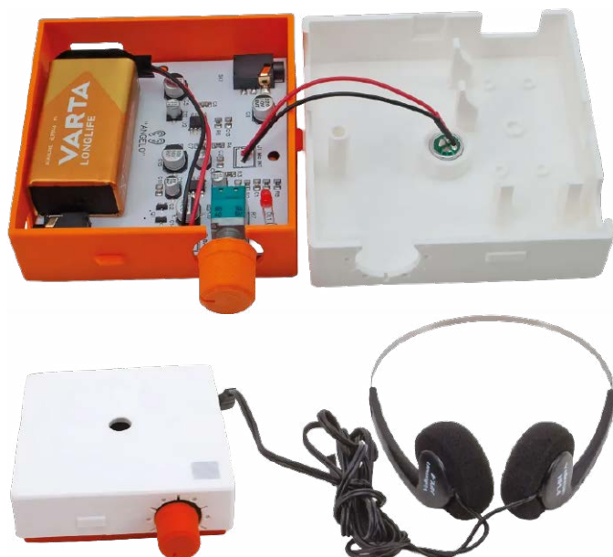
Fotografia Prototyp „Angelo”, obudowa z druku 3D oraz urządzenie gotowe do użycia ze słuchawkami
