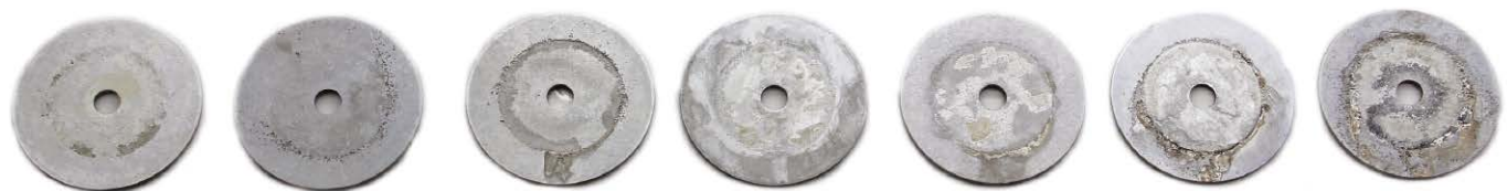
Rysunek 2. Zdjęcie próbki korozyjnej po 504 godz. od rozpylenia solanki/mgły solnej
