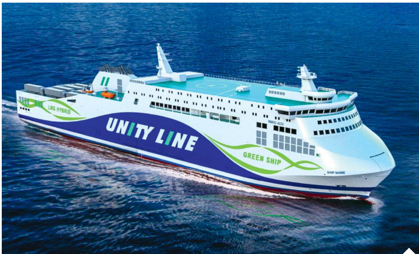
Gotowa jednostka będzie napędzana czterema silnikami na gaz LNG typu dual-fuel ze wspomaganie baterijnym | fot. mat. pras./d
