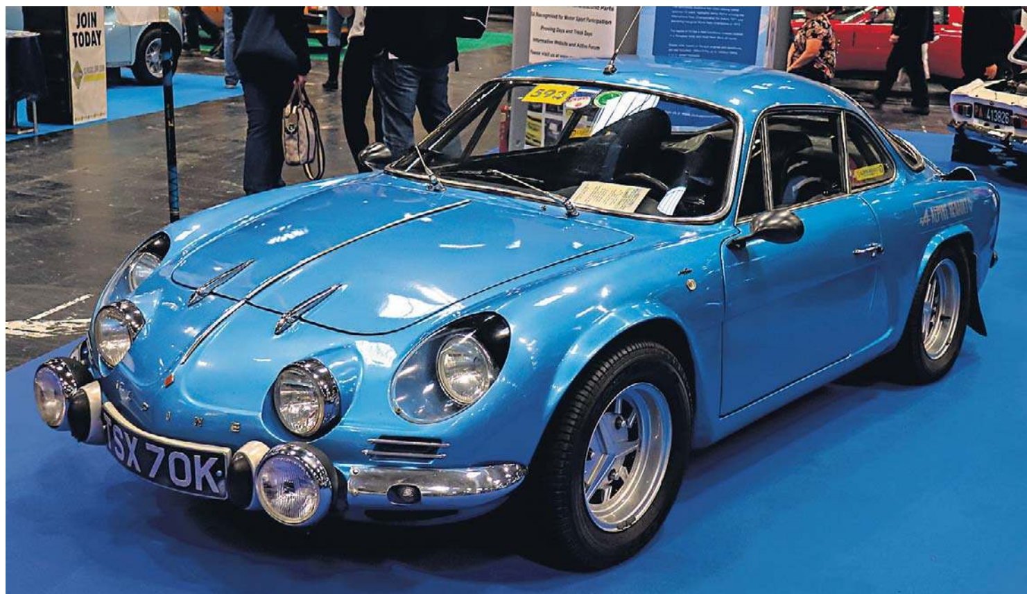
Na zdjęciu legendarny Alpine 110, produkowany w latach 1963–1974. Wykonane z włókna szklanego nadwozie zaprojektował Marcel Hubert. Mocno pochylona maska skrywała niewielki bagażnik, a silnik 1.3 o mocy 90 KM umieszczono z tyłu
