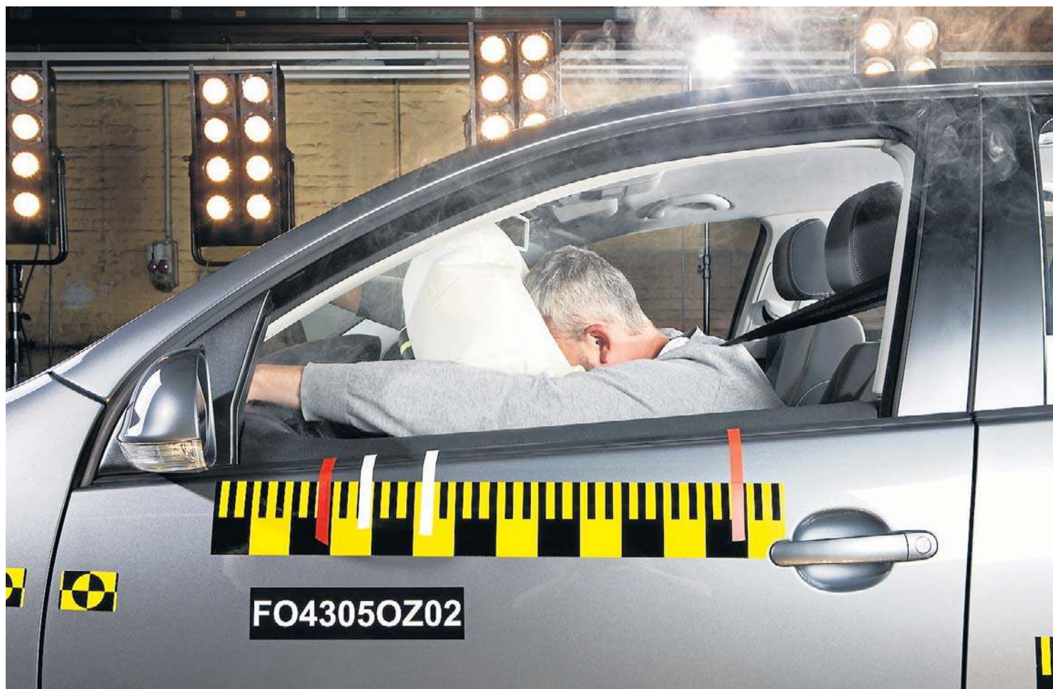
Poduszki, odpowiednio złożone i pokryte talkiem, ukryte są pod cienkimi warstwami tworzywa sztucznego. Oznaczane są skrótami SRS, SRS-Airbag lub Airbag, widocznymi w miejscach montowania. Po wystrzeleniu muszą zostać wymienione na nowe
