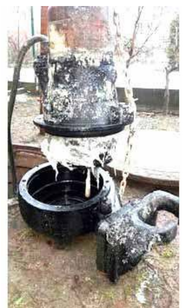
Pompa zatkana głównie przez chusteczki nawilżane. fot. Jung Pumpen
