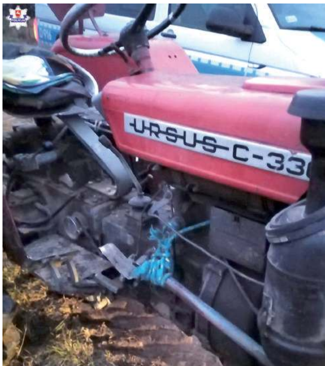
Układ kierowniczy ciągnika był związany sznurkiem. Kierował pijany traktorzysta
