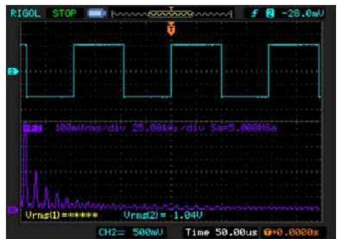
Rysunek 54. Analiza FFT sygnału prostokątnego
