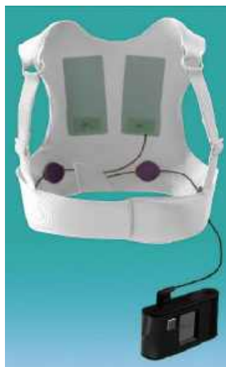
Fotografia 26. Ubieralny defibrylator z elektrodami w postaci kamizelki ( https://t.ly/LJX2f )
