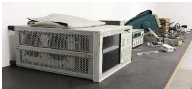
Fotografia 1. Stół warsztatowy autora artykułu – wykonany ze sklejki pokrytej odporną chemicznie warstwą
