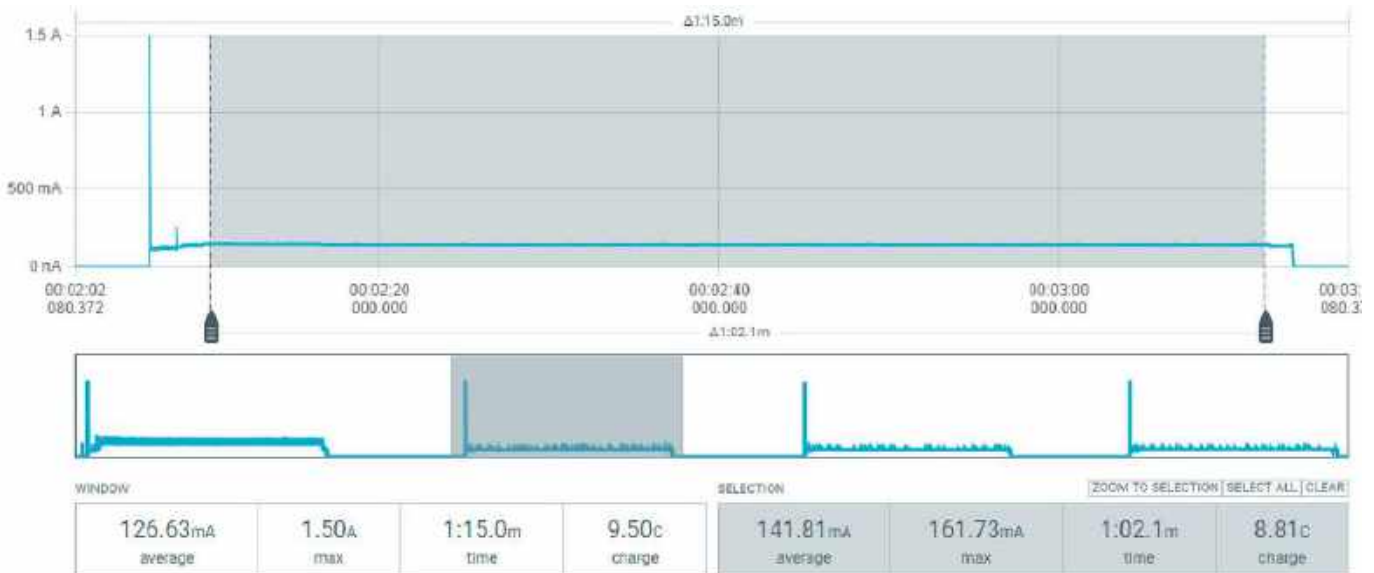
rysunek 1. Profil poboru prądu płytki Enviro Weather podczas kilku cykli pomiarowych
