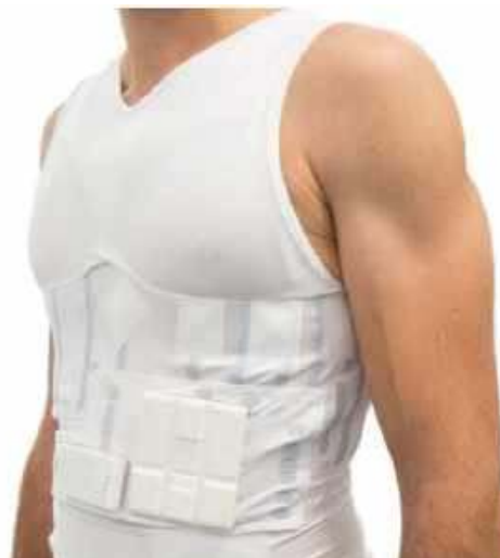
Fotografia 14. Koszulka z wbudowanymi elektrodami EKG ( https://t.ly/lx7dJ )
