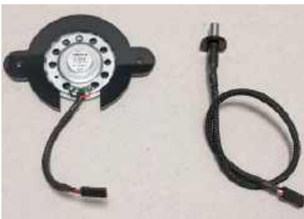
Fotografia 8. Uchwyty do przymocowania głośnika oraz czujnika temperatury
