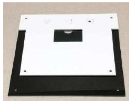
Fotografia 2. Szablon do wklejenia oznaczeń funkcyjnych oraz rzepu samoprzylepnego
