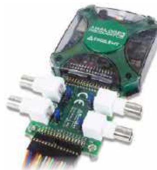
Fotografia 4. Urządzenie wielofunkcyjne Analog Discovery 2 marki Digilent [2]
