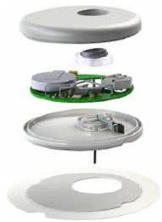
Fotografia 18. Budowa czujnika CGM marki Abbott ( https://t.ly/WOW66 )
