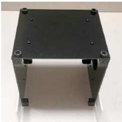
Fotografia 4. Przykręcenie gumowych stopki do dolnej części obudowy
