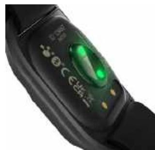
Fotografia 3. Czujnik fotopletyzmograficzny zamontowany w spodniej części obudowy opaski sportowej ( https://t.ly/57RbG )
