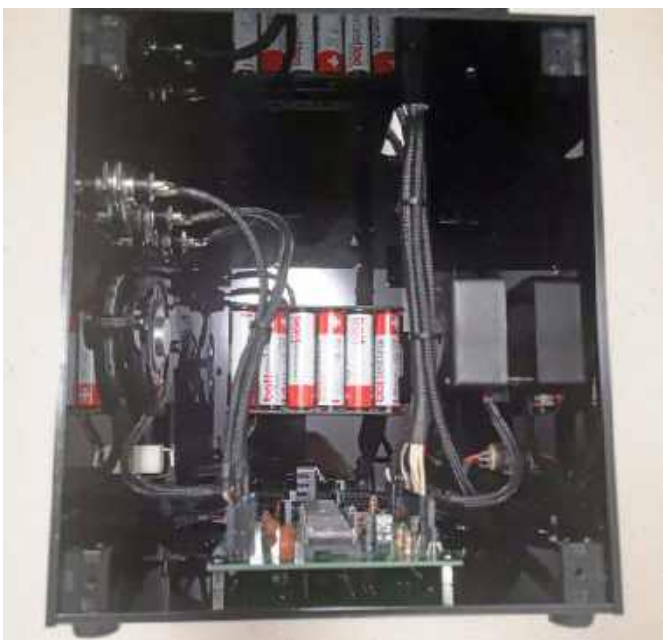
Fotografia 9. Wykonanie połączeń w dolnej części obudowy
