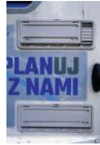
Trzeba pamiętać, aby podczas użytkowania lodówki zewnętrzne kratki wentylacyjne były otwarte
