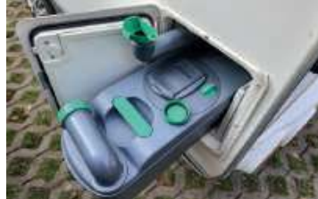
Kaseta toalety Thetford C500 z otwartym wlewem do napełniania zbiornika płynu spłukującego; z boku wnętrza znajduje się wskaźnik stanu płynu spłuczki
