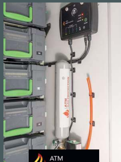
Bankomat z zainstalowanym systemem neutralizującym ataki gazowe oraz systemem barwienia banknotów w kasetach
