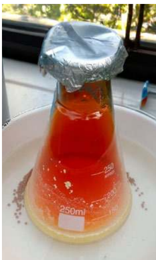
Fot. 9 – Mieszana podczas procesu nitrowania; sity molekularne w łaźni wodnej jako ewentualne zarodki wrzenia
