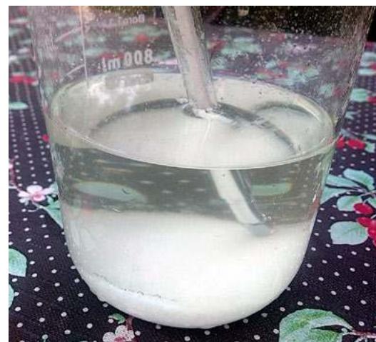
Fot. 14 – Wykryształowany wodorosiarczan(VI) hydrazyny
