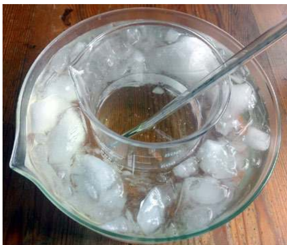
Fot. 12 – Roztwór podchlorynu chłodzony w łaźni lodowej
