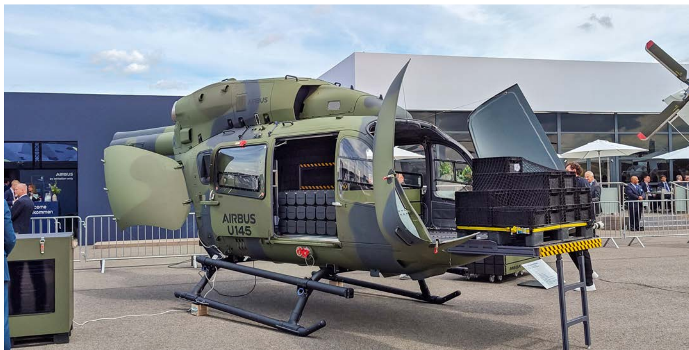
Makieta bezzałogowego śmigłowca Airbus U145, który bazuje na konstrukcji H145. Kabinę pilotów zastąpiła dodatkowa przestrzeń ładunkowa, do której prowadzą dwuskrzydłowe drzwi.
