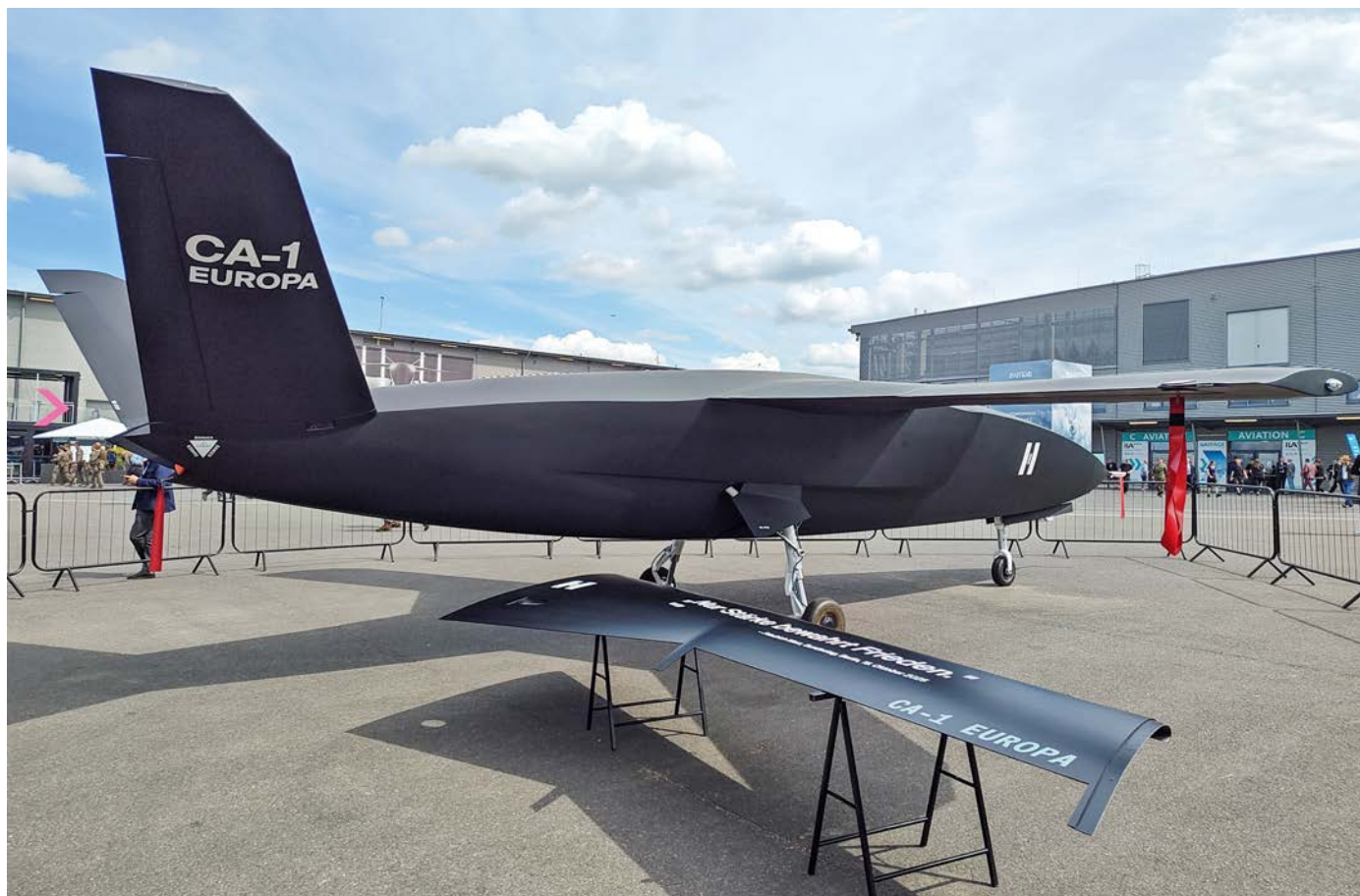
Rozwijana od podstaw przez niemiecką firmę Helsing bojowa platforma bezzałogowa CA-1 Europa . Obok pełnowymiarowej makiety zaprezentowano fragment skrzydła powstającego prototypu. Maszyna układem konstrukcyjnym mocno przypomina MQ-28.
