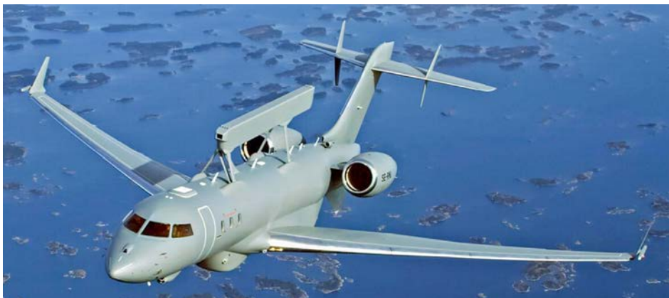
Saab GlobalEye wykorzystuje zmodyfikowany płatowiec komercyjnego bizjeta Bombardier Global 6000/6500 , który został dostosowany przez Saaba do przenoszenia radaru Erieye ER oraz innych zaawansowanych czujników i systemów. Fot. Saab
