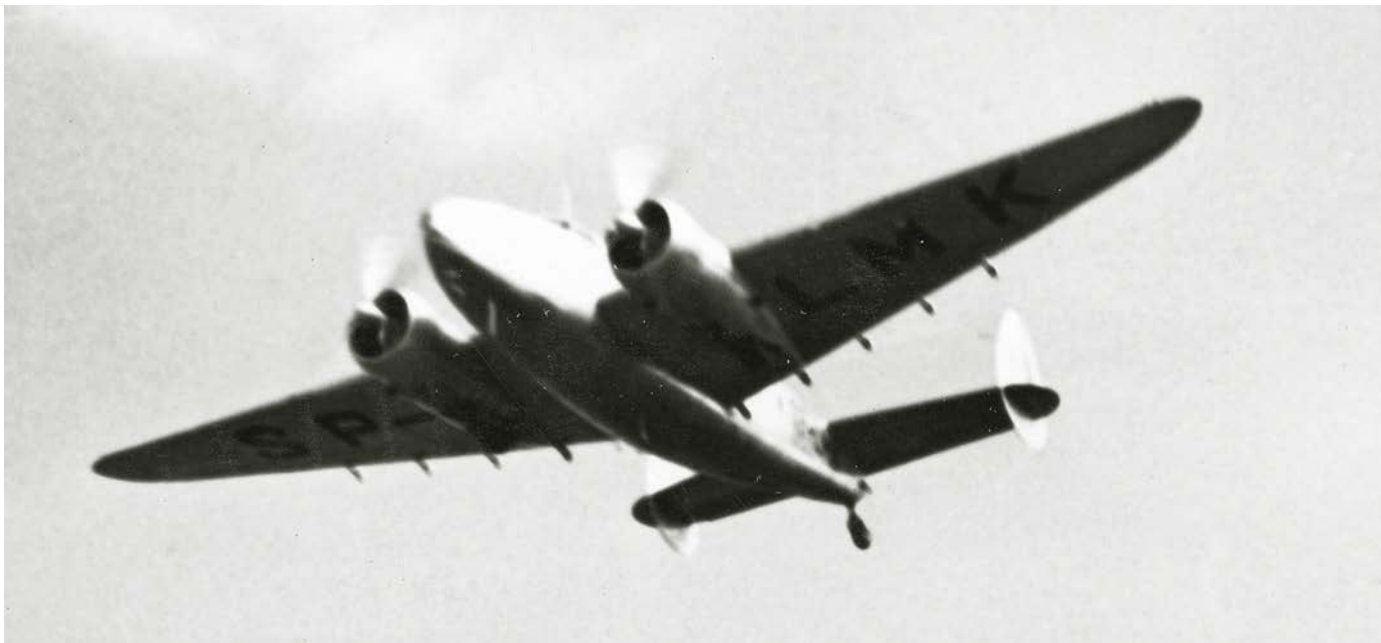
L-14H Super Electra SP-LMK (nr fabr. 1425) w niskim przelocie nad lotniskiem Okęcie w czerwcu 1938 roku. Ze względu na delikatną konstrukcję podwozia te samoloty nie były predestynowane do operowania z lotnisk polowych czy improwizowanych lądowisk. Fot. NAC
