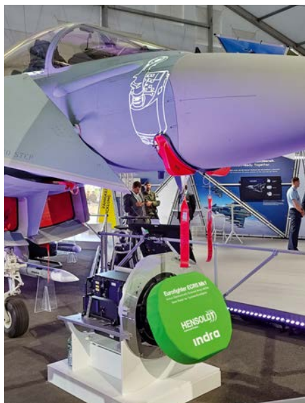
Prezentowany przy niemieckim myśliwcu Eurofighter Typhoon nowy radar ECRS Mk 1 z anteną AESA.
