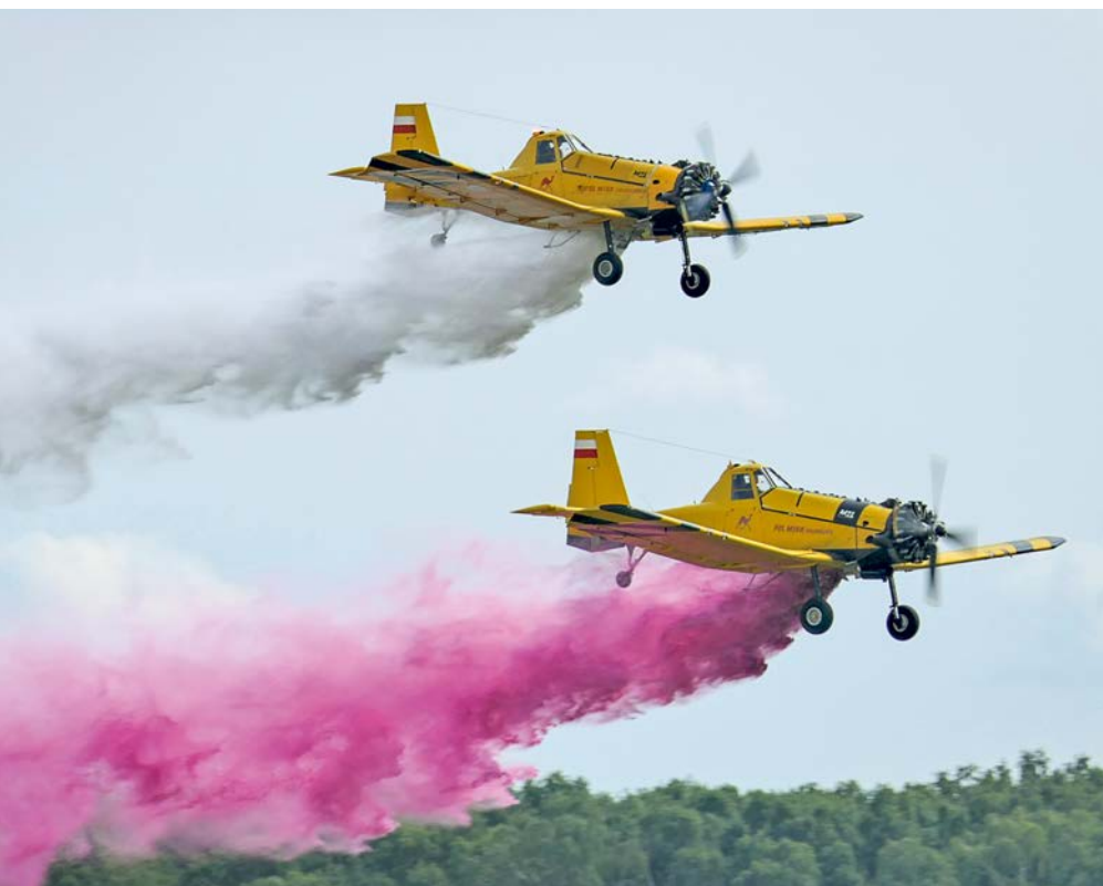
Dwa M18B podczas tzw. smużenia lub zraszania. Tą techniką gasi się tłące się połacie otwartego terenu, np. łąki, ścierniska, busz. W celach pokazowych wodę może być barwiona na kolor czerwony za pomocą dodania nadmanganianu potasu. Fot. Marcin Strembski
