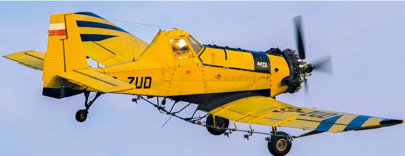
M18B Dromader (SP-ZUD) z zamontowaną pod płatem instalacją służącą do prowadzenia oprysków upraw rolniczych. Fot. Marcin Strembski
