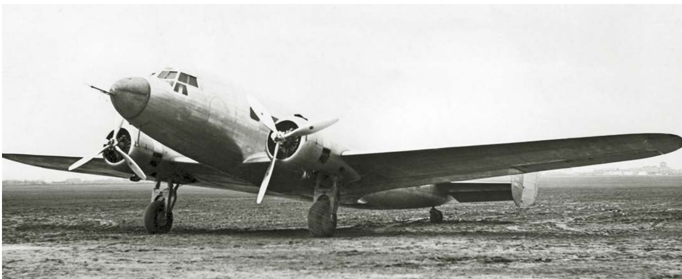
PZL-44 Wicher na Okęcie. Ze względu na długi rozbieg i dobieg ta prototypowa konstrukcja nie była predestynowana do operowania z lotnisk polowych czy improwizowanych lądowisk. Wicher został przekazany LOT-owi 29 grudnia 1938 roku. Symptomatyczne, miesięczne opóźnienie w rozpoczęciu prób eksploatacyjnych wskazuje na rezerwę niektórych decydentów w odniesieniu do perspektywy – chociażby wyłącznie testowego – użytkowania przez LOT nowego samolotu komunikacyjnego krajowej proweniencji. W próbach Wichra w locie, realizowanych w PLL LOT od 30 stycznia 1939 roku, aktywnie uczestniczył pilot W. Klisz (wraz z pilotami K. Bocheńskim, F.K. Długaszewskim, T.T. Karpińskim, J.G. Mitzem i M.S. Płonczyńskim). Właśnie wcześniej zdobyte doświadczenie stało się powodem powierzenia W. Kliszowi dowodzenia Wichrem w godzinach popołudniowych 1 września. W czasie wrześniowych operacji samolot nosił oznaczenia polskiego Lotnictwa Wojskowego (szachownice). Fot. NAC
