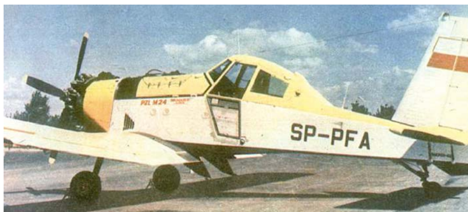
Pierwszy prototyp M24 Dromader Super (SP-PFA; nr ser. 1AKP01-02) z silnikiem ASz-62IR i śmigłem AW-2 został oblatany 20 lipca 1987 roku przez Andrzeja Pamułę. Ten wariant Dromadera został opracowany w latach 1980–1981 w zespole kierowanym przez inż. Józefa Oleksiaka.
