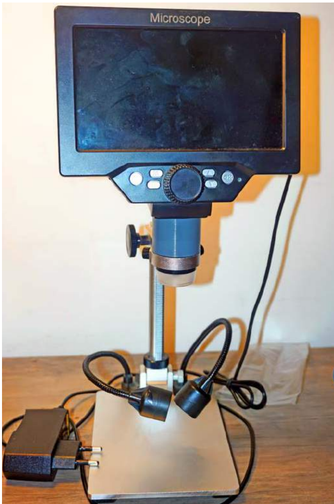
Fotografia 1. Kompletny mikroskop z dołożoną tuleją dystansową
