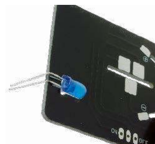
Fotografia 1. Sposób profilowania wyprowadzeń diod LED
