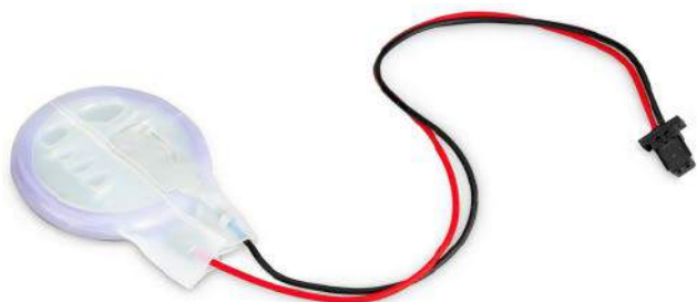
Fotografia 6. Akumulator podtrzymujący RTC (z materiałów fundacji)
