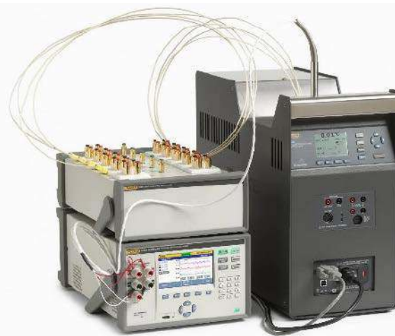
Fotografia 26. Ultra-precyzyjny system pomiaru i rejestracji temperatury 1586A Super-DAQ wraz z kalibratorem Fluke 9190A ( https://t.ly/yDyNH )
