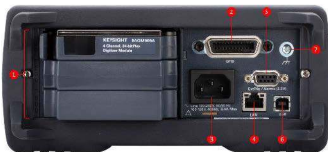
Fotografia 3. Widok panelu tylnego jednostki DAQ973A marki Keysight. 1 – sloty rozszerzeń, 2 – złącze interfejsu GPIB, 3 – gniazdo zasilania AC, 4 – gniazdo interfejsu Ethernet, 5 – port sygnałów dodatkowych (alarmy, wyzwalanie), 6 – gniazdo USB, 7 – zacisk uzimienia ( https://t.ly/0rPjh )
