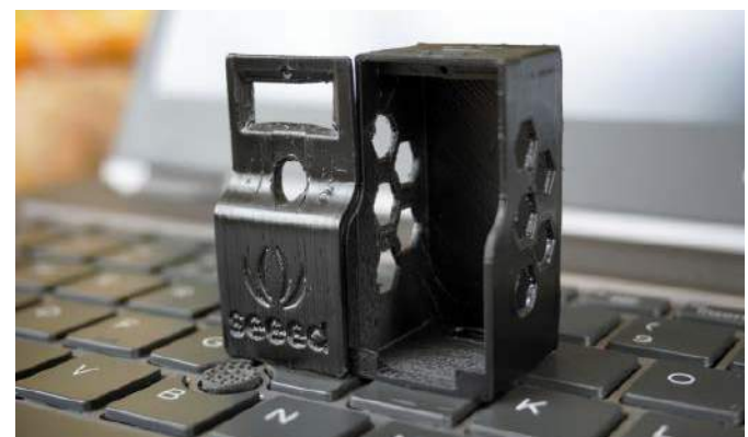
Fotografia 1. Obudowa z druku 3D dla sensora gestów
