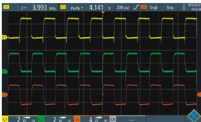
Rysunek 2. Żółte i zielone przebiegi pokazują komplementarne sygnały sterujące przyłożone do przetwornika piezoelektrycznego. Oba sygnały mają częstotliwość 3,99 kHz i amplitudę międzyszczytową zbliżoną do 3 V, bez uwzględnienia skoków przesterowania. Czerwony sygnał przyłożony do przetwornika jest pokazany na czerwonym przebiegu i wynosi międzyszczytowo 6 V
