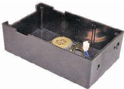
Obudowa UB1 Jiffy box z wklejonym głośnikiem oraz trzema szczelinami i trzema otworami wymaganymi na ściankach obudowy. Należy również wywiercić w podstawie obudowy okrągły wzór otworów, aby umożliwić wydobywanie się dźwięku
