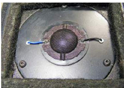
Rysunek 20. Przegroda LS3/5A. Filcowe paski wokół głośnika wysokotonowego redukują zakłócenia dyfrakcyjne od krawędzi ramki maskownicy. W przeciwieństwie do większości głośników, LS3/5A pracuje lepiej z założoną maskownicą. Po jej zdjęciu pojawia się wcięcie w charakterystyce na częstotliwości 6,5 kHz
