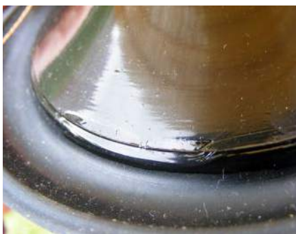
Rysunek 18. Dopięcie głośnika nisko-średniotonowego wykonane za pomocą warstwy tłumiącej wiskoelastycznej o wysokiej histerezie zmniejsza ilość przesterowań. Powłoka ta jest widoczna na tylnej ścianie membrany B110A
