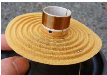
Rysunek 28. Zespół membrany B110A. Należy zwrócić uwagę na otwory w cewce z Nomexu, aby zapobiec wzrostowi ciśnienia pod osłoną przeciwpływową (co jest częstą przyczyną zniszczeń)
