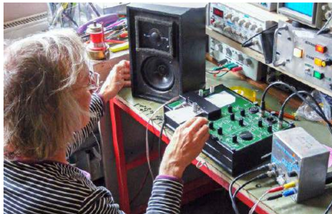
Rysunek 4. Do wykreślenia charakterystyki częstotliwościowej głośnika potrzebny jest co najmniej generator sygnałowy i multimetr z odczytem dB. Po lewej – osobiście używam Neutrika Audiograph 3300 z 1981 roku; po prawej – Neutrik i generator stałoprądowy używany do pomiaru krzywej impedancji
