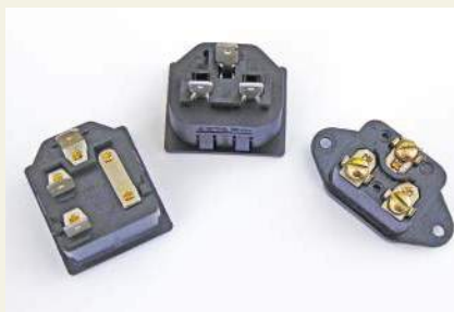
Rysunek 3.27. Trzy rodzaje męskich gniazd typu IEC – widok od tyłu. Należy unikać wersji z połączeniami śrubowymi (po prawej), gdyż trudno takie połączenia odpowiednio zaizolować
