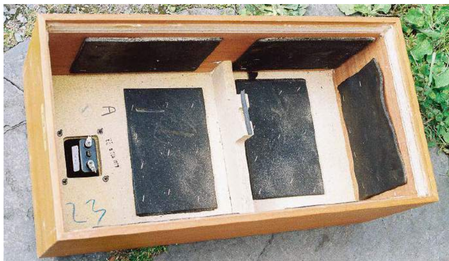
Rysunek 19. Tłumienie paneli głośników za pomocą podkładek tłumiących karoserię samochodową zmniejsza vibrację. Na zdjęciu prezentowane jest wnętrze obudowy KEF 104ab. (W moich demonstracjach w sali wykładowej, skradzionych z wykładów Lauri Fincham, znajdują się dwa kawałki sklejek – jeden z tłumieniem, drugi bez. Po uderzeniu patką jeden z nich wibruje, drugi wydaje tępy stukot)
