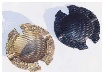
Rysunek 30. Maskownica membrany T27
