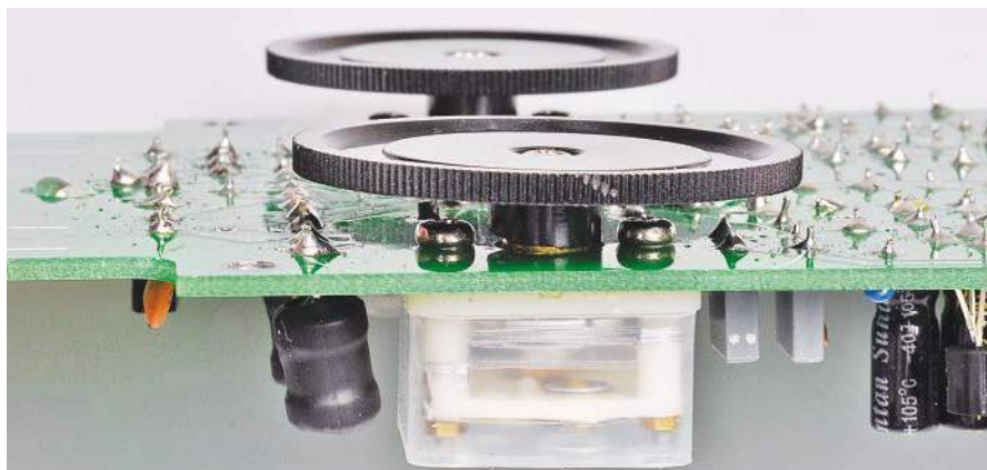
To zbliżenie płytki drukowanej pokazuje, jak zamocowane są dwa kondensatory zmienne (w rzeczywistości są to miniaturowe kondensatory do strojenia radia AM). Jeśli okaże się, że pokrętło zaczepia się lub blokuje na płytce lub obudowie, być może trzeba będzie wyregulować jego położenie lub pogłębić szczelinę
