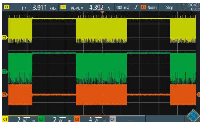
Rysunek 3. Ten oscylogram pokazuje te same sygnały komplementarne, ale przy znacznie mniejszej szybkości przemiatania (100 ms / div). Sygnały mają długość ok. 280 ms i są oddzielone przerwami o długości ok. 220 ms. Czerwony przebieg pokazuje całkowity sygnał przyłożony do przetwornika i wynosi międzyszczytowo 6 V
