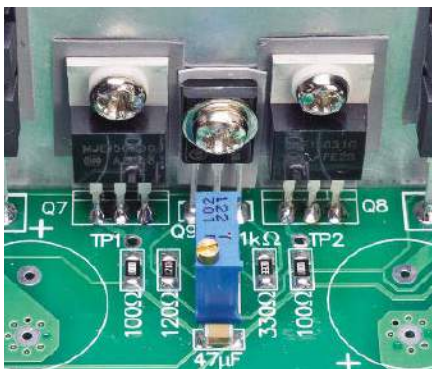
Ten widok pokazuje szczegóły montażu tranzystora mnożnika VBE (Q9) oraz dwóch tranzystorów sterujących (Q7 i Q8). Sprawdźmy, czy wszystkie te tranzystory oraz cztery tranzystory wyjściowe (Q10-Q13) są odizolowane od radiatora
