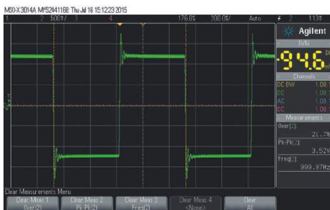
Zakres 2: ten sam test co w Zakresie 1, ale z kondensatorem 2 \mu F na obciążeniu. Powoduje to większe przekroczenie zakresu (~20%) i pewne dzwonienie, ale wszystko jest pod kontrolą. Jest to standardowy test stabilności wzmacniacza
