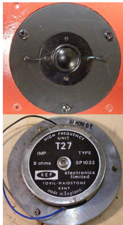
Rysunek 29. Widok z przodu/z tyłu na tweeter KEF T27
