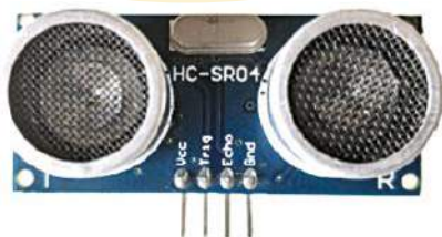
Rysunek 2. Szczegóły styków czujnika HC-SR04
