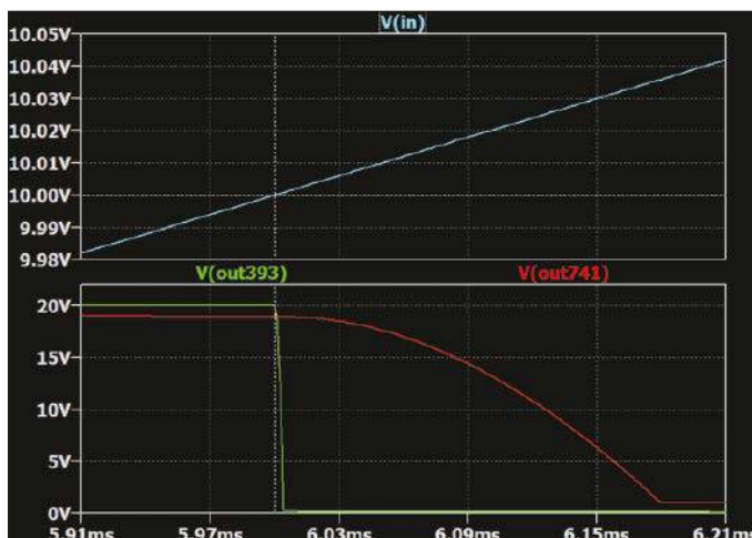
Rysunek 7. Wyniki symulacji układu z rysunku 6. Cursor (biała linia przerywana) wskazuje moment, w którym próg został przekroczony
