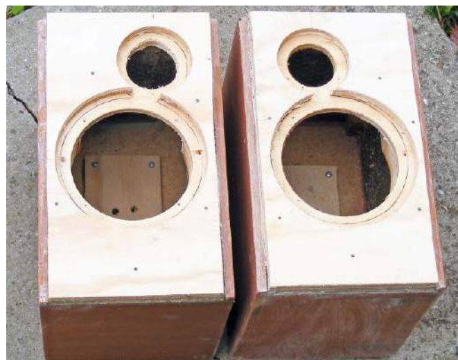
Rysunek 16. Montaż głośników niejako „chowający je” w płaszczyźnie obudowy pomaga zminimalizować efekty filtrowania grzebieniowego w paśmie górnych częstotliwości, spowodowane narastającym efektem dyfrakcji. Obudowy dla przetworników Wavecor mają fronty wykonane z dwóch sklejkowanych kawałków sklejk
