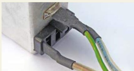
Rysunek 3.29. Używanie koszulek termokurczliwych do zabezpieczenia przełączników, bezpieczników i konektorów
