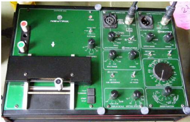
Rysunek 4. Do wykreślenia charakterystyki częstotliwościowej głośnika potrzebny jest co najmniej generator sygnałowy i multimetr z odczytem dB. Po lewej – osobiście używam Neutrika Audiograph 3300 z 1981 roku; po prawej – Neutrik i generator stałoprądowy używany do pomiaru krzywej impedancji
