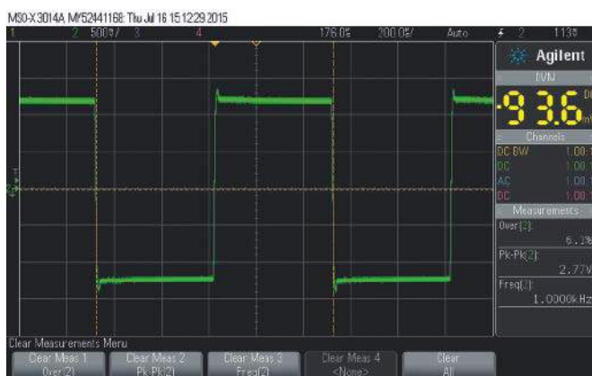
Zakres 1: sygnał wyjściowy wzmacniacza dla fali prostokątnej o częstotliwości 1 kHz przy obciążeniu 4-ohmowym. Jak widać, występuje niewielkie przesterowanie (około 5%), ale szybko powraca do normalnego stanu, z bardzo niewielkim dzwonieniem
