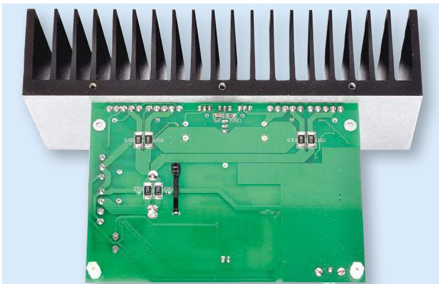
W podstawie radiatora można wywiercić i nagwintować trzy otwory M3 lub M4, tak aby można go było później przymocować do obudowy. Wykonajmy je na głębokość ok. 10 mm.
