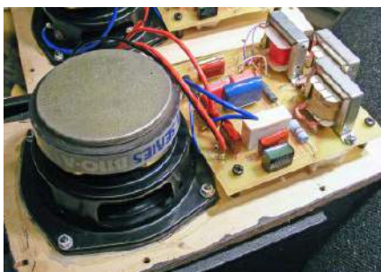
Rysunek 21. Tylne części przegrody LS3/5A z widoczną zwrotnicą. Została ona zamontowana ponad magnesem głośnika wysokotonowego przy użyciu filcowej podkładki o grubości 3/8 cala, aby zapobiec grzechotaniu. Obawiałem się, że magnes będzie wpływał na cewkę ale nie udało mi się zmierzyć żadnej istotnej różnicy
