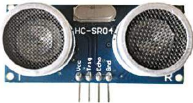
Rysunek 2. Szczegóły styków czujnika HC-SR04
