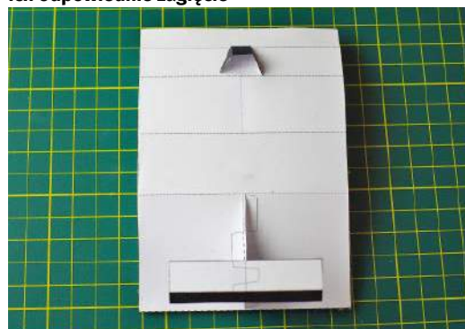
5. Do tylnej części kadłuba przykleja się sklejone wcześniej usterzenie typu „T”
