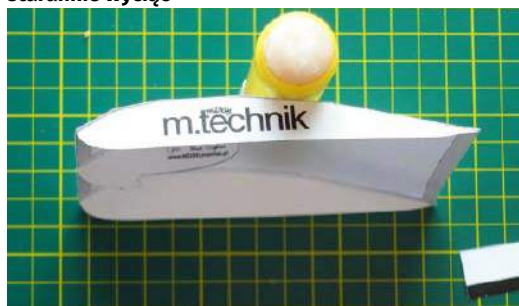
4. Burty przykleja się do dłuższych krawędzi kadłuba (trzeba zwrócić uwagę na oznaczone linie zagięć). W części dziobowej, od spodu, wkleja się podwójnej grubości zaczep startowy
