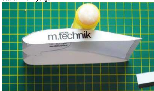
4. Burty przykleja się do dłuższych krawędzi kadłuba (trzeba zwrócić uwagę na oznaczone linie zagięć). W części dziobowej, od spodu, wkleja się podwójnej grubości zaczep startowy
