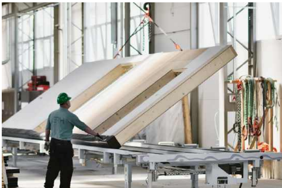
Ściana domu – prefabrykat drewniany jeszcze w fabryce. MULTICOMFORT SAINT-GOBAIN/ECOREADYHOUSE
