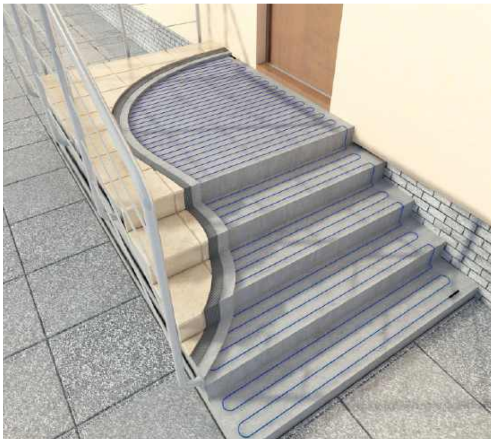
➤ Na schodach przewody grzejne układa się na stopnicach, czyli poziomych powierzchniach. ELEKTRA
