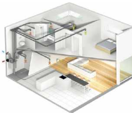
❶ Schemat działania wentylacji mechanicznej z rekuperatorem. vasco
