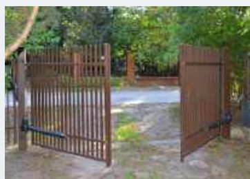
Siłowniki (proste) przytwierdzono do obu skrzydeł bramy.
