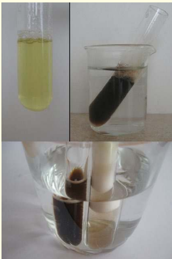
Fot. 5. Doświadczenie 7. U góry: z lewej roztwór białka jaja kurzego w wodzie, z prawej – ciemny osad siarczku ołowiu(II). U dołu: utlenianie siarczku ołowiu do siarczanu (probówka po lewej – siarczek, probówka po prawej – siarczan).
