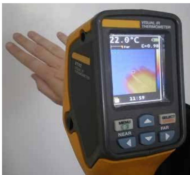
Fot. 3. Procedura rejestracji termogramu dłoni zdrowego człowieka ( \epsilon = 0,98 ).
