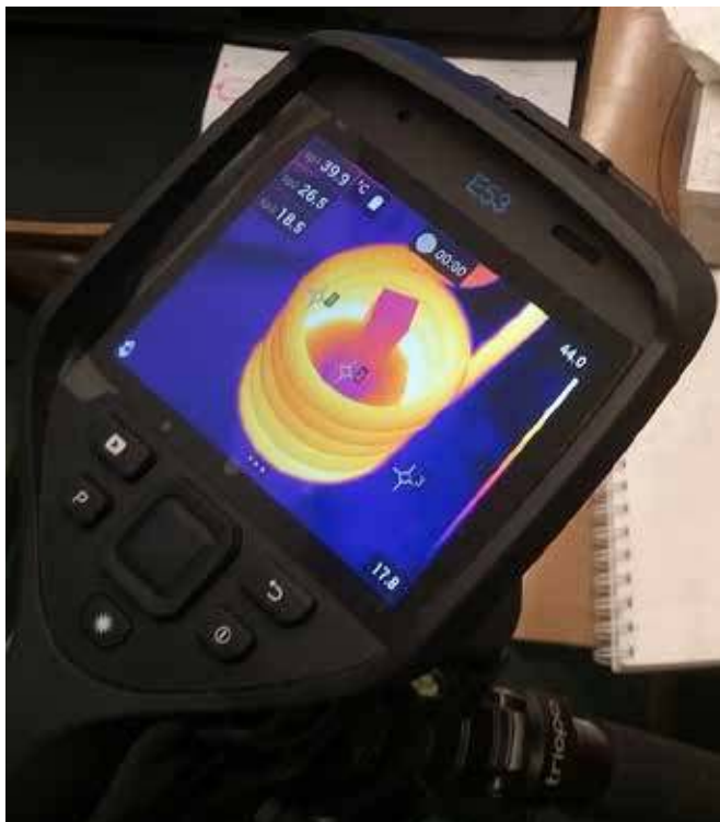
Fot. 5. Nałożenie obrazów zarejestrowanych w podczerwieni i w świetle widzialnym umożliwia wizualizację zarówno temperatury jak i konturów obiektu, w tym przypadku rozgrzanej cewki w eksperymencie z hipertermią magnetyczną.
