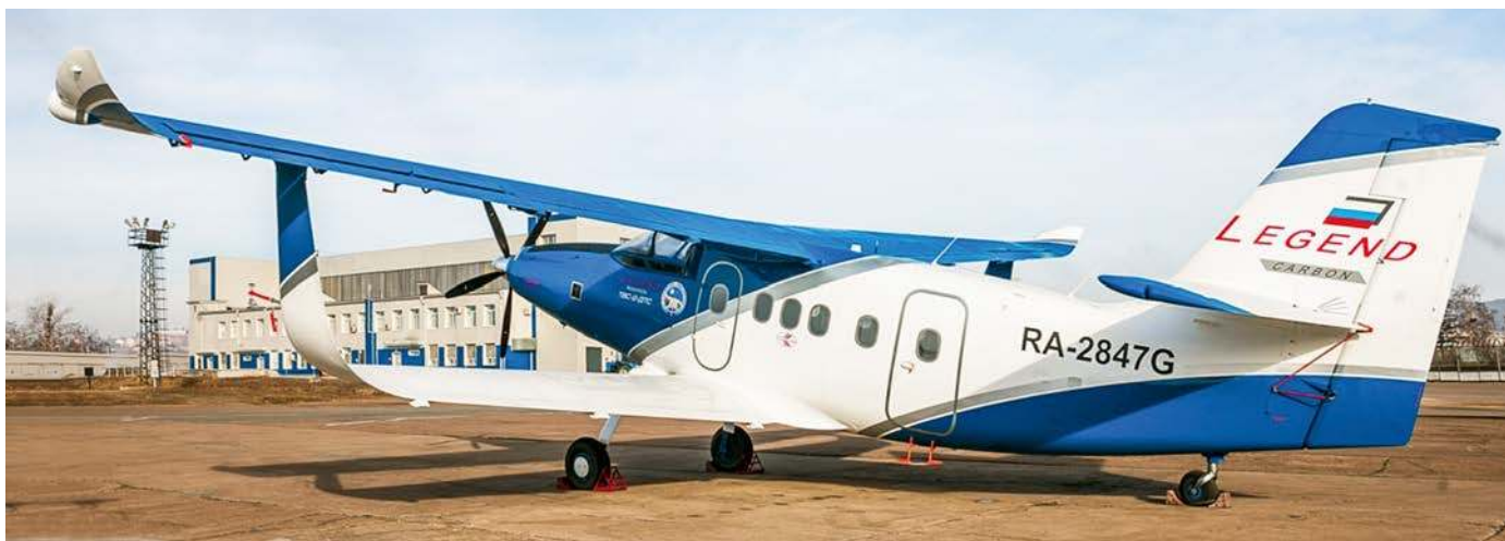
Demonstrator technologii TWS-2DTS (rej. RA-2847G) zakładał budowę samolotu wzorowanego na Anie-2, ale z kadłubem wykonanym z kompozytów, napędzanego amerykańskim silnikiem Honeywell TPE331 i wyposażonym w nowoczesną awionikę.
