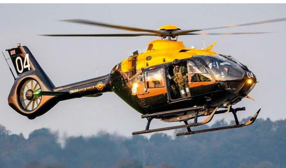
Śmigłowiec wielozadaniowy H135 Juno HT1. Maszyny tego typu (oraz Jupiter HT1) służą do szkolenia pilotów i członków załóg wiroplatów wszystkich rodzajów Brytyjskich Sił Zbrojnych. W AAC szkolenie prowadzi 660 i 670 Squadron AAC podlegające No. 1 Flying Training School (1 FTS) RAF.
