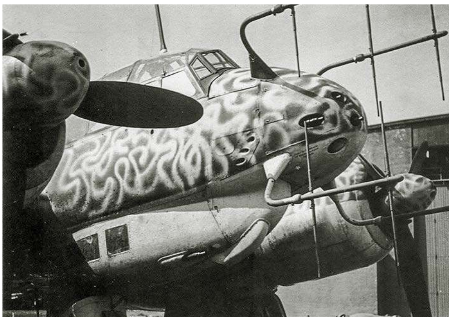
Nocny myśliwiec Junkers Ju 88R z charakterystycznymi antenami radaru pokładowego FuG 220 Lichtenstein SN-2.
