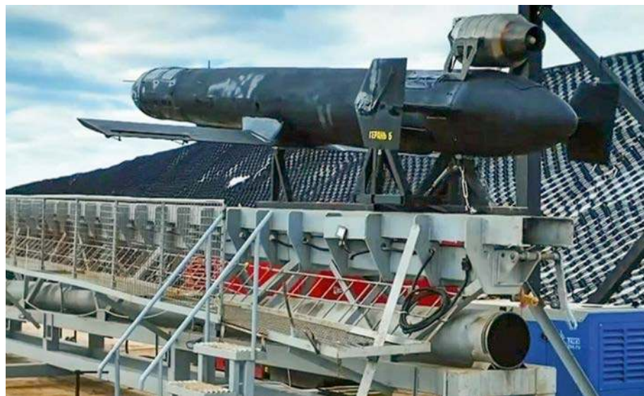
Niskokosztowy pocisk manewrujący Geran-5 na wyrzutni startowej. Chociaż niektórzy usiłują dopatrzeć się podobieństwa do pocisku HESA Karrar , to rosyjski Geran-5 jest wyraźnie odmienną konstrukcją, być może tylko koncepcyjnie inspirowaną irańskim odpowiednikiem.
