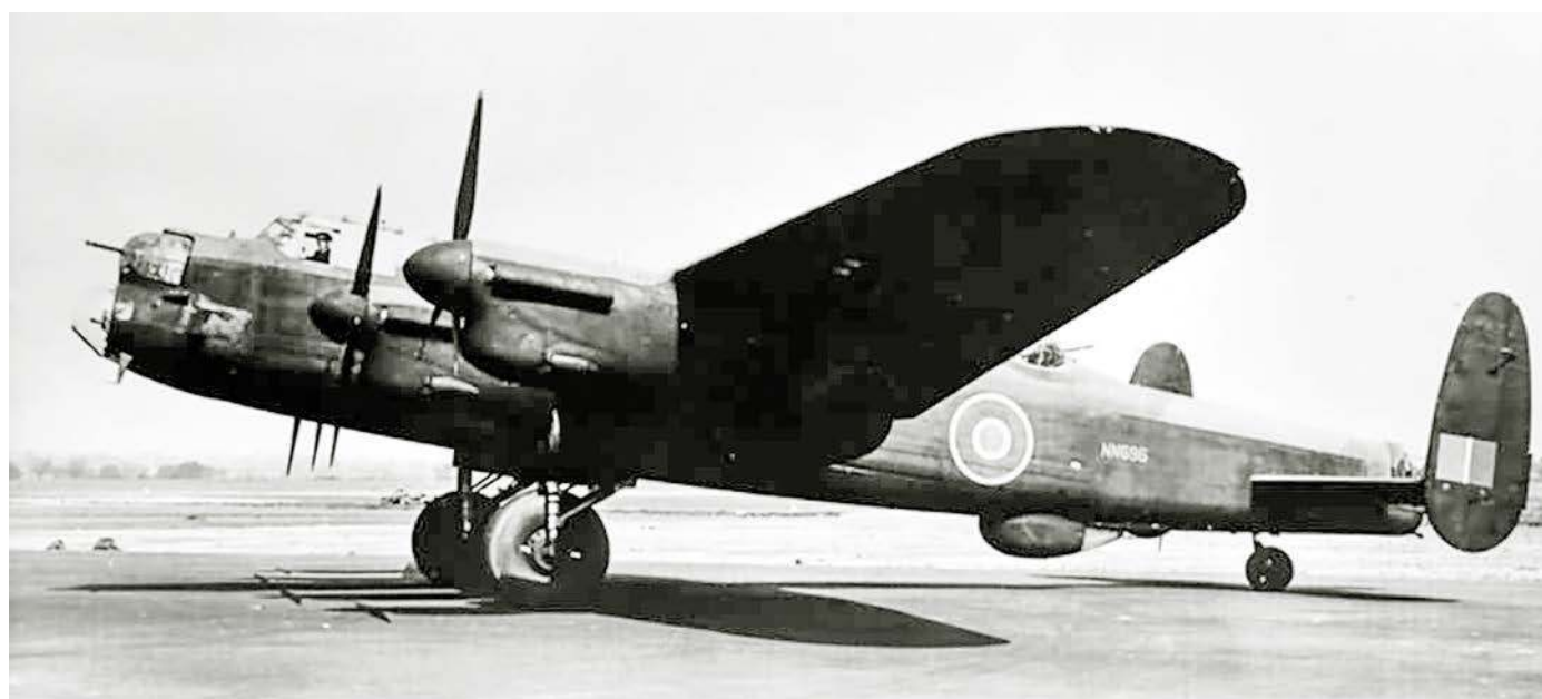
Lancaster NN696 DX-H, w którym 22 czerwca 1944 roku zginął F/Sgt Charles H.T. Hurley, który 17 grudnia 1943 roku jako jedyny ocalał z wodowania Lancastera JB373 DX-N z 57. Squadronu . Pod kadłubem maszyny widoczna jest osłona radaru nawigacyjnego H2S, z którym dowództwo Bomber Command wiązało duże nadzieje na poprawienie skuteczności bombardowań.
