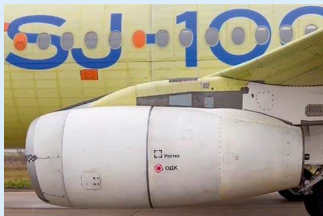
Silnik PD-8 zainstalowany pod skrzydłem samolotu SJ-100. Na gondoli widoczne są logotypy ODK (Zjednoczonej Korporacji Silnikowej) i jej właściciela konglomeratu Rostiech. Fot. OAK
