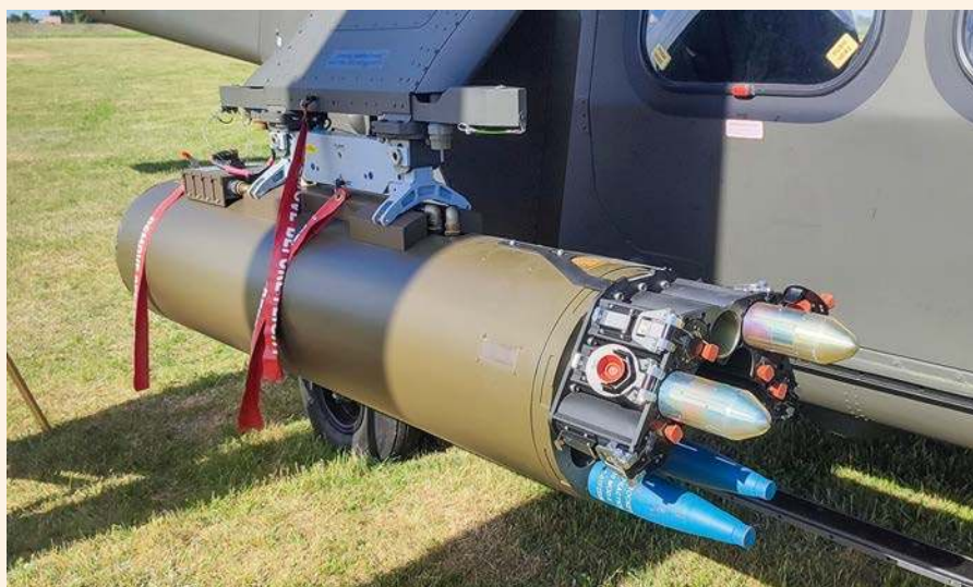
Oba rodzaje belgijskiej amunicji rakietowej kal. 70 mm, w wersjach niekierowanej FZ123 oraz kierowanej FZ275 LGR, są certyfikowane do wyrzeliwania z 19-lufowych wyrzutni FZ225 FZ223 zakupionych wraz ze śmigłowcami AW149.
