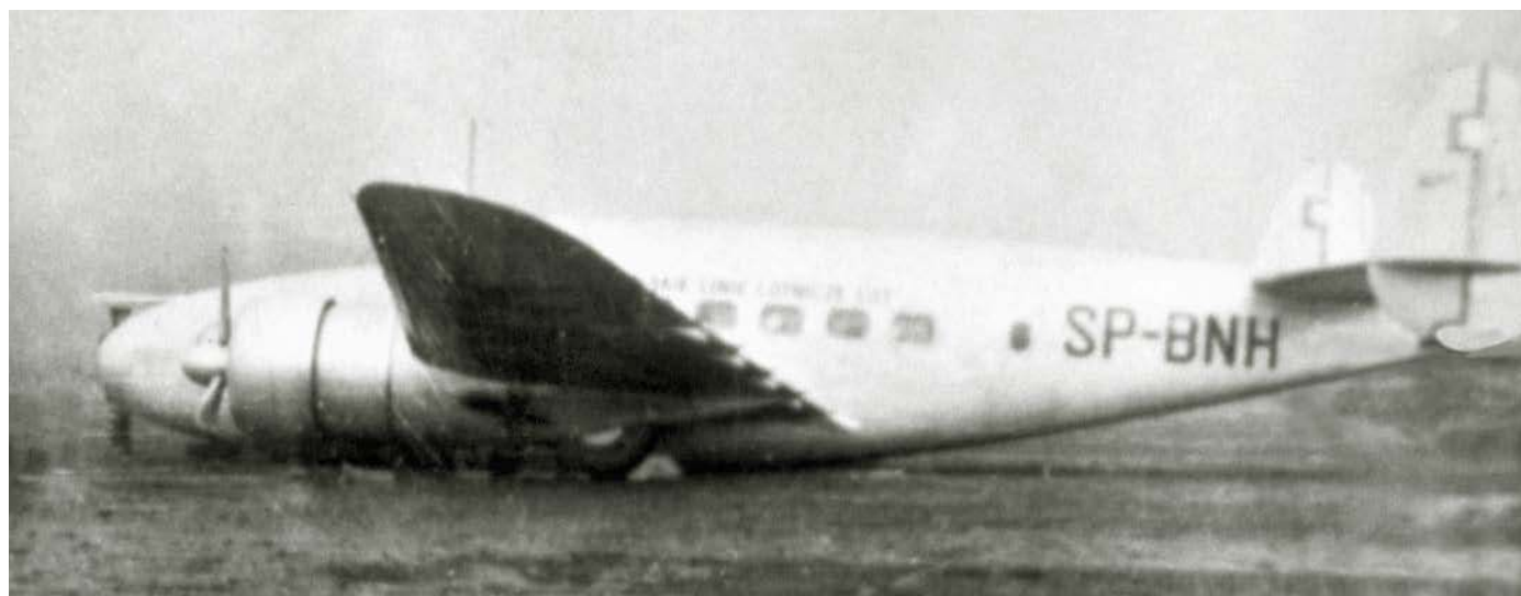
Uszkodzony Lockheed L-14H Super Electra SP-BNH na lotnisku Bukareszt-Băneasa. Zdjęcie wykonane najprawdopodobniej 13 września 1939 roku, tj. nazajutrz po udanym manewrze lądowania ze schowanym podwoziem. Konieczność lądowania w Bukareszcie (zamiast odejścia na lotnisko zapasowe) była konsekwencją opisanych w tekście praktyk realizacji przelotów z ograniczoną ilością paliwa, aby zapobiec próbom ewentualnych ucieczek załóg LOT-u.
