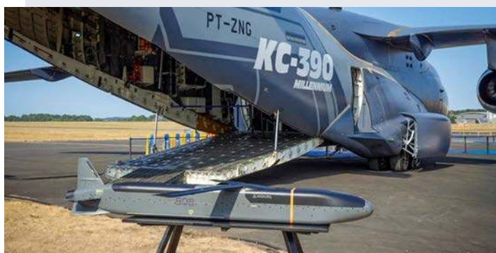
Pociski Barracuda-500M mają być masowo zrzucane z rampy transportowego samolotu Embraer C-390, co pozwoli atakować niskim kosztem znacznie oddalone cele. Fot. Embraer
