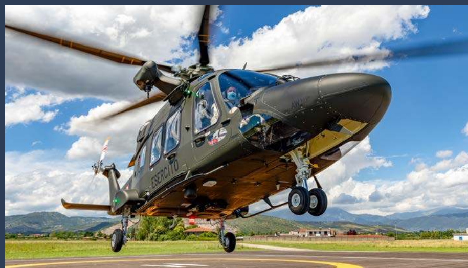
Kompozytowy płatowiec śmigłowca AW169 jest w całości produkowany w PZL-Świdnik.
