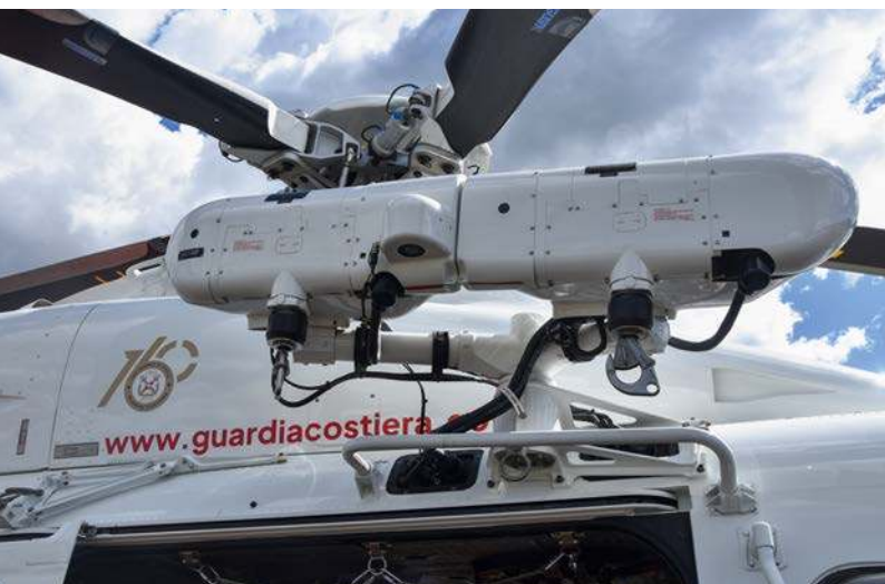
Śmigłowiec PH-139E dysponuje podwójną wciągarką ratowniczą.
