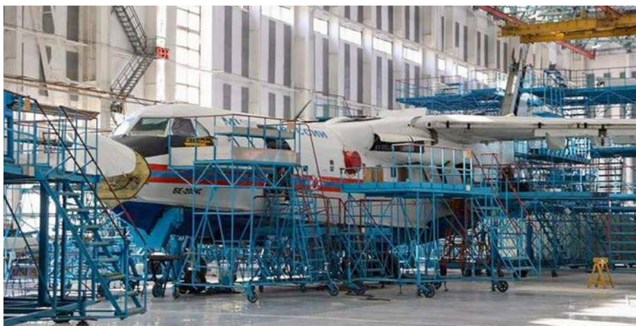
Pierwszy seryjny Be-200CzS (RF-32765) w hali TANTK podczas przebudowy w celu zainstalowania silników PD-8, październik 2024 roku. Fot. TANTK
