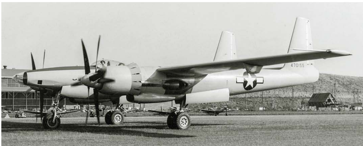
Howard Hughes w kokpicie pierwszego prototypu XF-11 (44-70155) na lotnisku w Culver City. Próbné kołowania rozpoczęły się 15 kwietnia 1946 roku. W ich trakcie dochodziło do wycieków oleju z przekładni śmigła prawego silnika.
