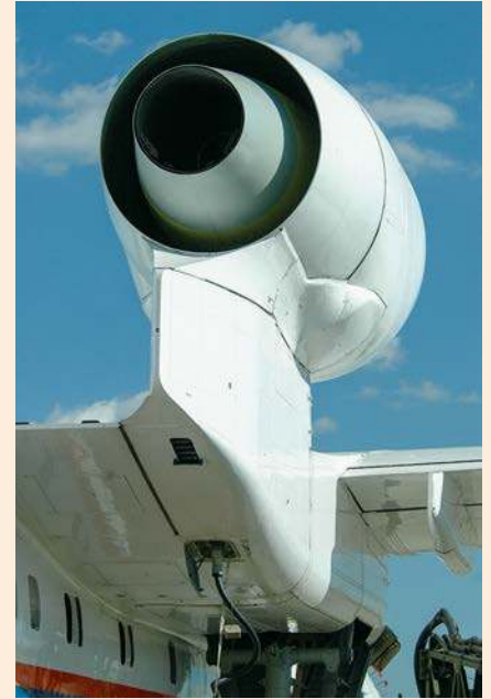
Silniki turbodrzutowe D-436TP zamontowano na pylonach nad skrzydłem, aby zapobiec dostawaniu się wody do wlotów powietrza podczas startu i lądowania.
