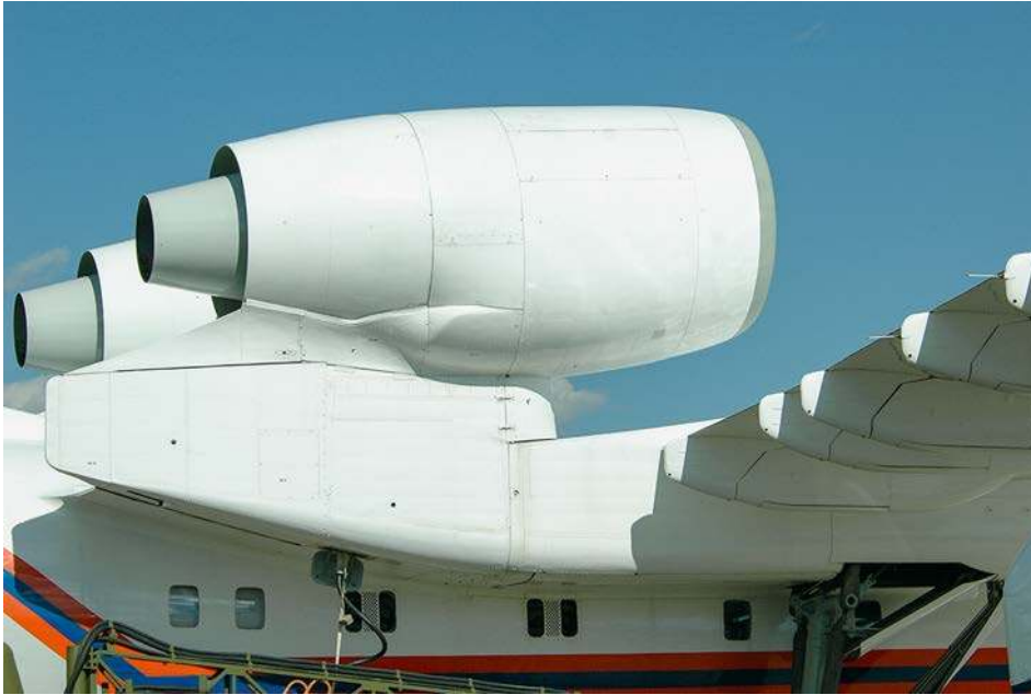
Silniki turbodrzutowe D-436TP zamontowano na pylonach nad skrzydłem, aby zapobiec dostawaniu się wody do wlotów powietrza podczas startu i lądowania.
