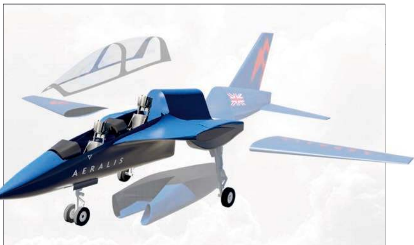
Konstrukcja projektowanego AJT opierała się na wspólnym kadłubie, do którego można było dostosowywać różne warianty zespołu napędowego i skrzydeł. Fot. Aeralis
