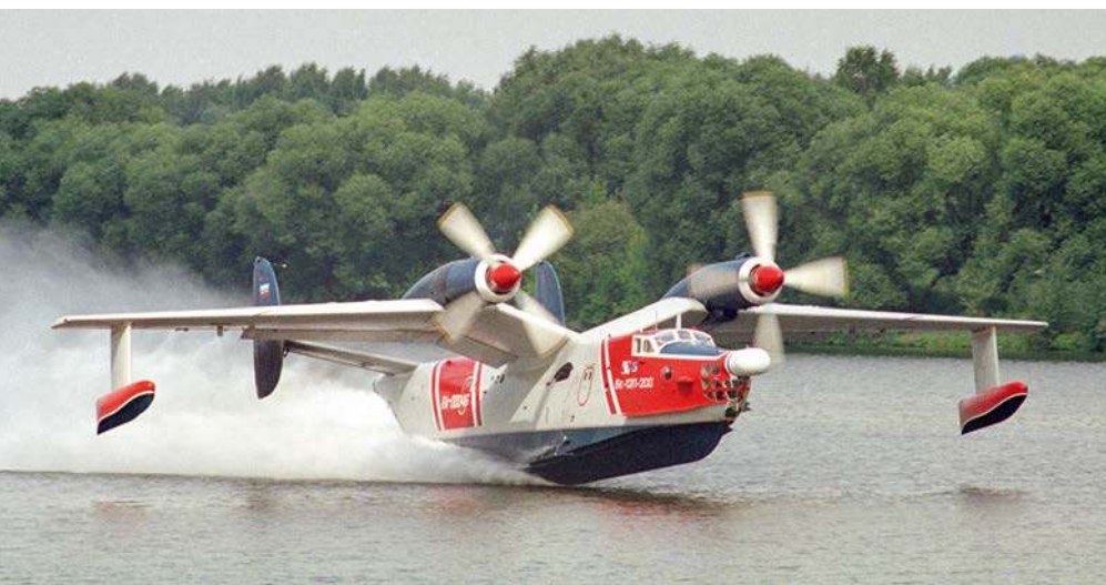
Amfibia Be-12P-200 (RA-00046) służąca jako samolot doświadczalny do badań systemu pobierania wody do zbiorników podczas ślizgu przy dużej prędkości na potrzeby programu samolotu Be-200.
