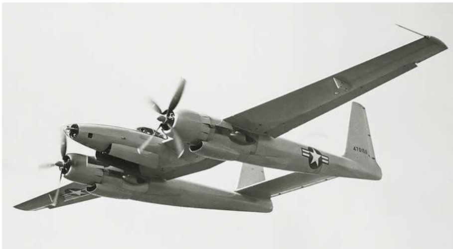
Drugi prototyp XF-11 (44-70156) podczas prób w Wright Field w 1948 roku. Samolot ma już nowe znaki rozpoznawcze USAF, z czerwonymi paskami na białych pasach po bokach gwiazdy. Na pylonach pod skrzydłami mogły być podwieszane dodatkowe zbiorniki paliwa, ale podczas prób XF-11 nigdy z nich nie skorzystano.
