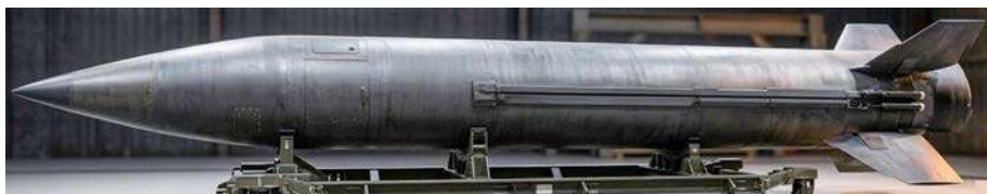
Pocisk balistyczny FP-7 jest mocno zbliżony do pocisku przeciwlotniczego 48N6 dla systemów przeciwlotniczych S-400 i najprawdopodobniej wykorzystuje jego elementy, które odtworzono metodą inżynierii wstecznej.
