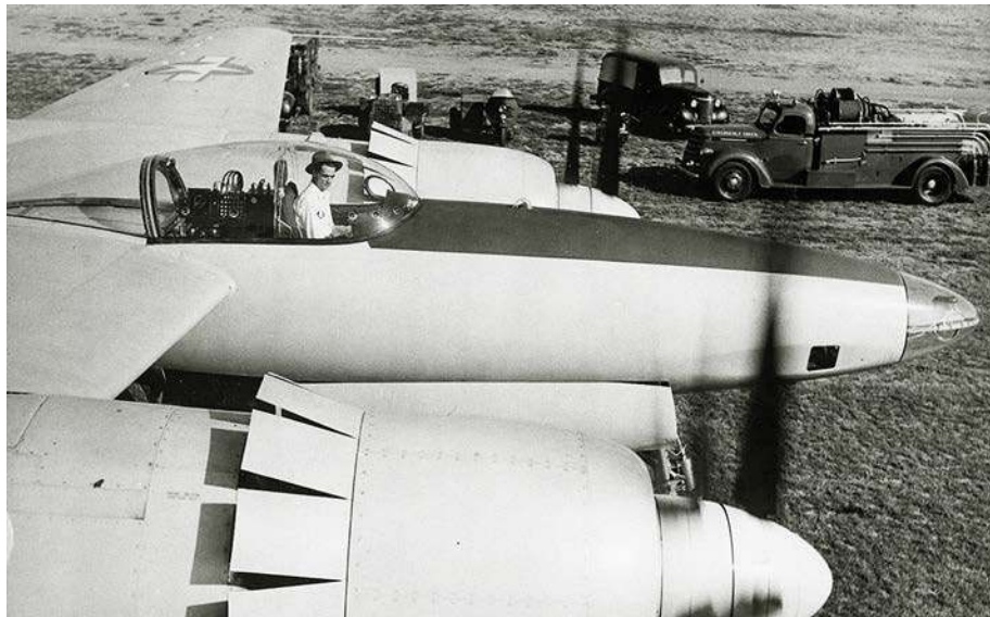
Howard Hughes w kokpicie pierwszego prototypu XF-11 (44-70155) na lotnisku w Culver City podczas próby silników. Ten egzemplarz był napędzany silnikami R-4360-31 z osmioletkami Hamilton Standard.
