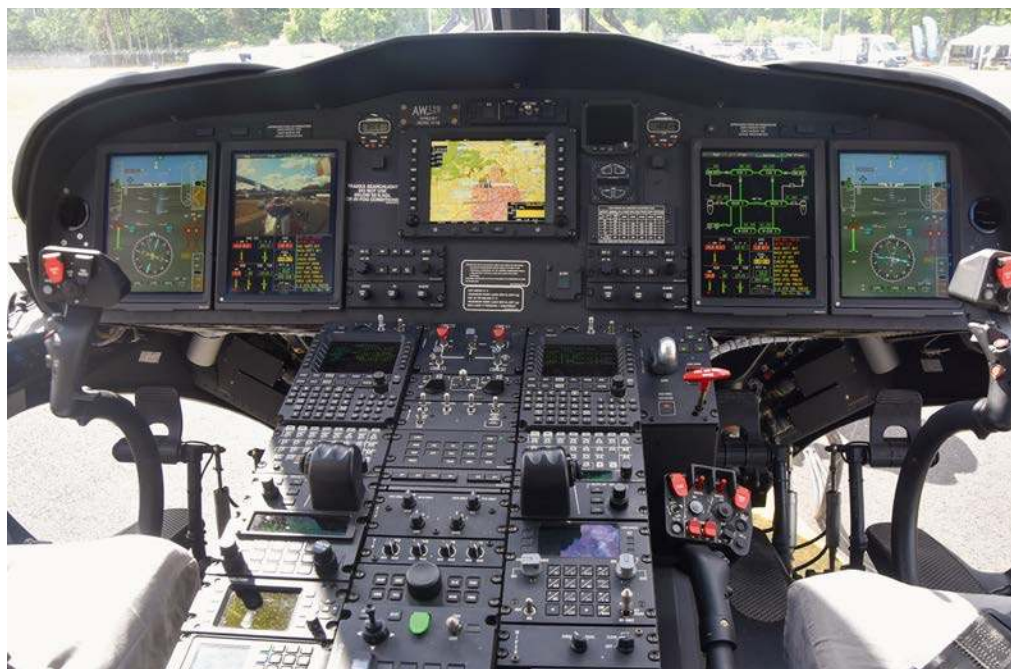
Kabina śmigłowca PH-139E z dużymi wyświetlaczami wielofunkcyjnymi.
