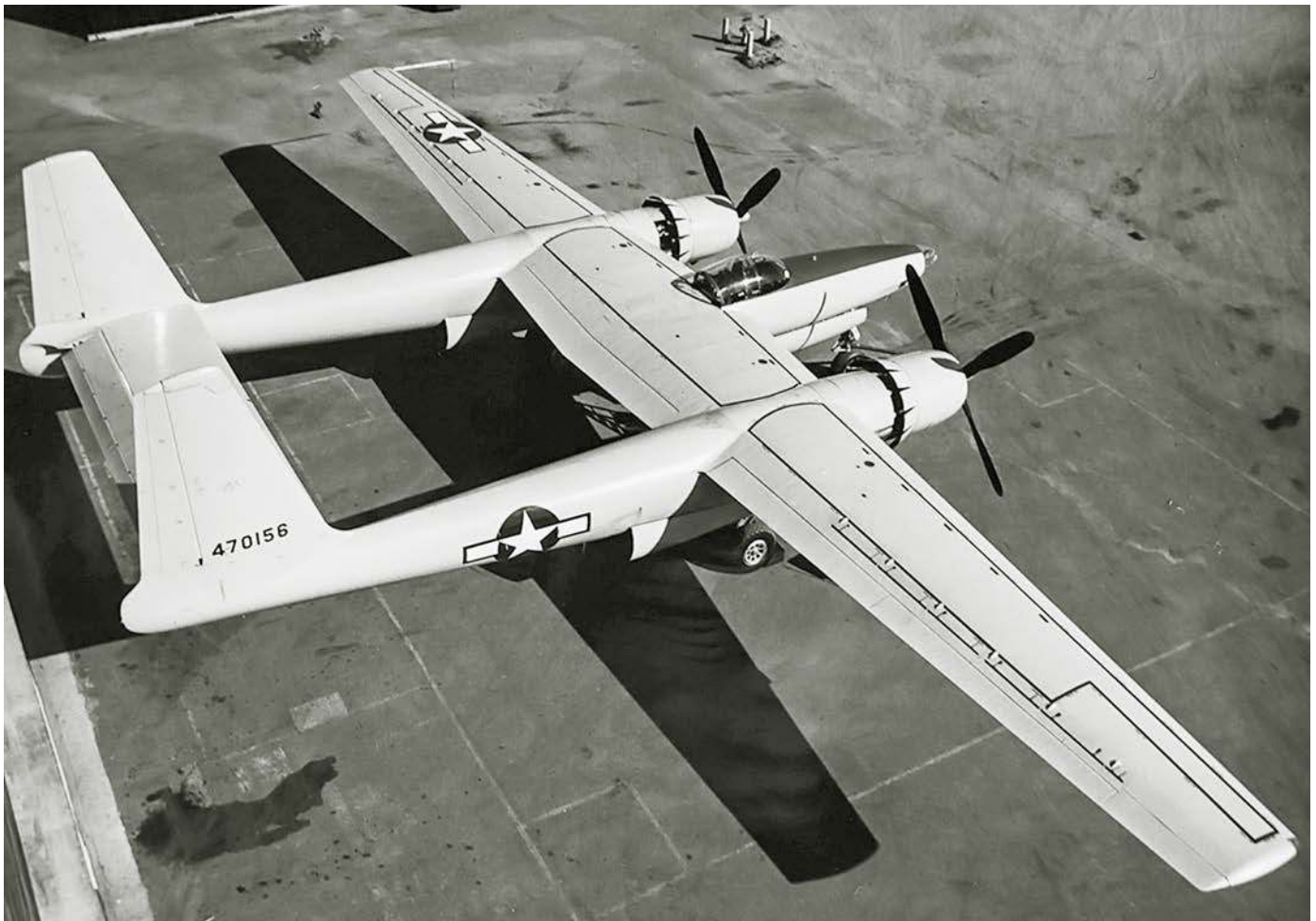
Drugi prototyp XF-11 (44-70156). Do sterowania przechyleniami przy dużej prędkości służyły spoilery zainstalowane na górnej powierzchni skrzydeł, które przy małej prędkości były wspomagane przez niewielkie lotki umieszczone przy końcówkach skrzydeł. Pozostałą część krawędzi spływu zajmowały pięciosegmentowe klapy szczelinowe.
