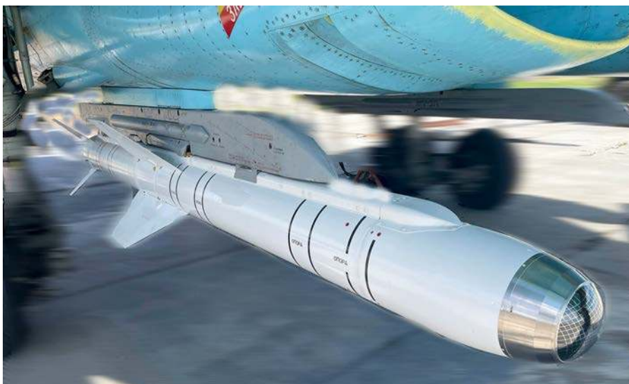
Pocisk raketowy powietrze-ziemia krótkiego zasięgu Ch-38ML pod kadłubem rosyjskiego samoloty uderzeniowego Su-34.
