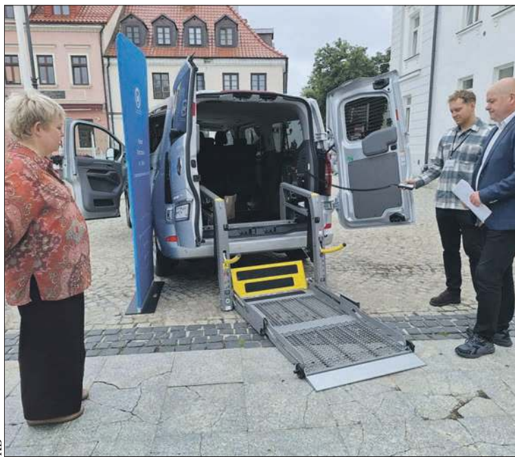
Nowy bus w tylnej części posiada windę o udźwigu do 400 kg
