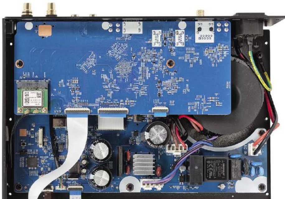
Elektronikę rozplanowano na dwóch poziomych płytkach.
