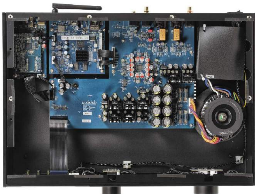
Obwody rozdzielono między cztery główne płytki drukowane.
