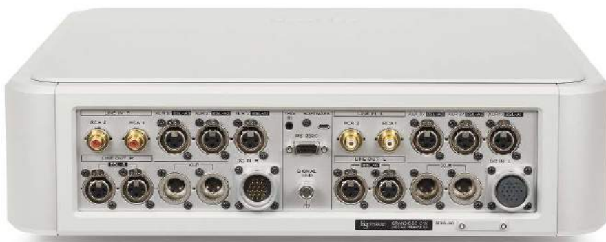
Panel przyłączeniowy przedwzmacniacza ogranicza się do sygnałów analogowych; Esoteric zachowuje funkcje cyfrowe dla wyspecjalizowanych urządzeń.
