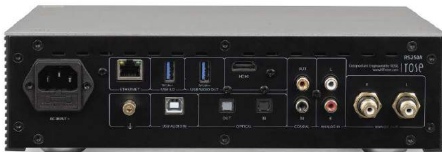
RS250A to nie tylko źródło strumieniowe, ale centrum multimedialne z połączeniami audio i wideo.
